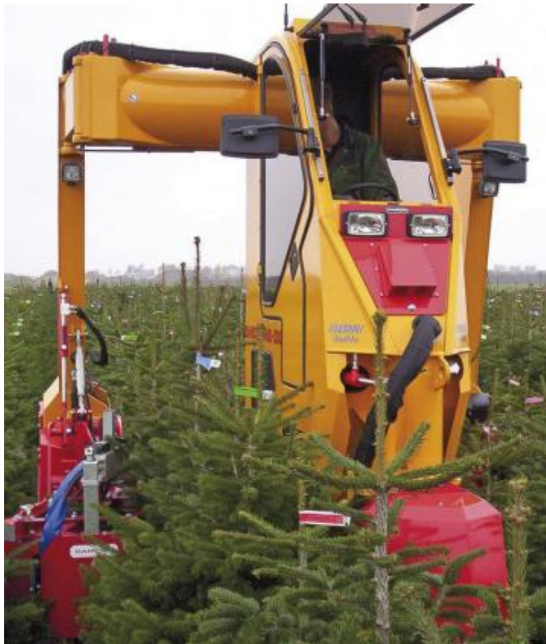
Fig. 2.10 - Porta attrezzi scavallante della ditta Damcon al lavoro in un vivaio di abeti di Natale.
