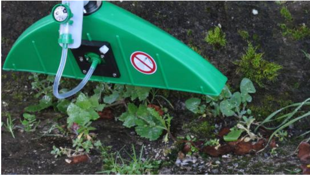
Fig. 2.12 - Distribuzione di aceto per il diserbo naturali mediante una nebulizzazione schermata del prodotto (Minimantra)
