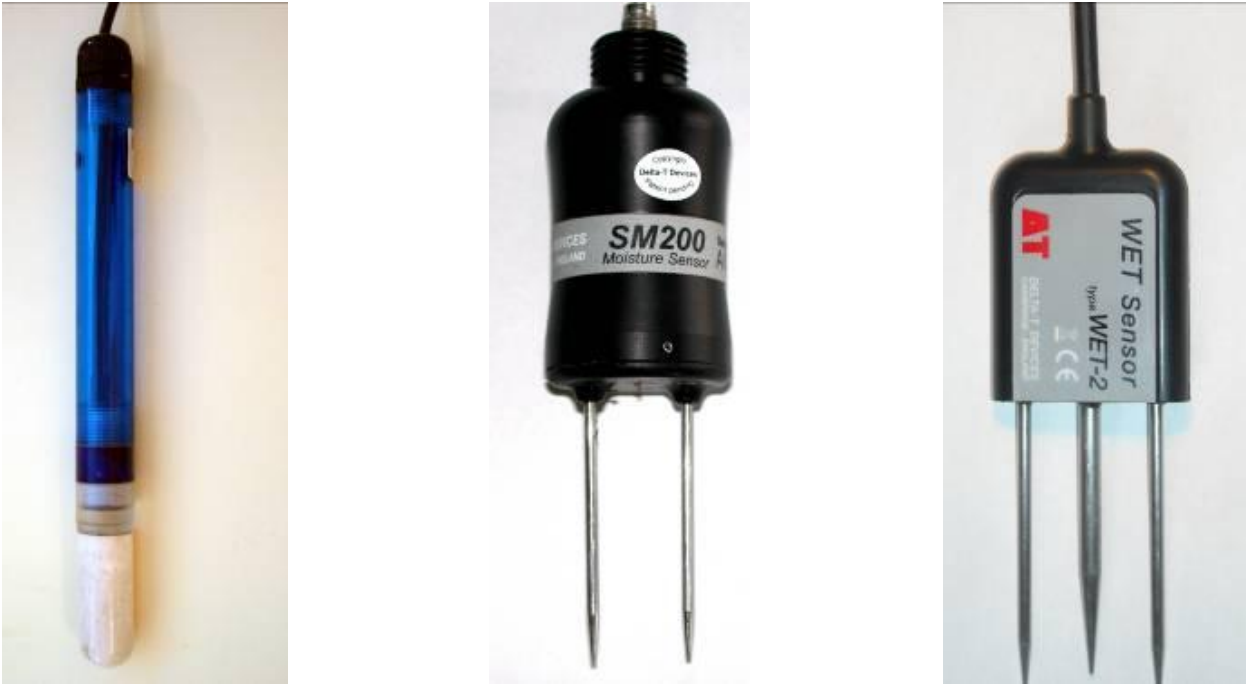
Fig. 1.4 - Alcuni esempi di sensori per la misura dell'umidità del terreno e del substrato: tensiometro idraulico (a sinistra), che misura il potenziale idrico; sensore dielettrico SM200 (Delta-T Devices, Burwell, UK), che misura il contenuto idrico volumetrico; sensore WET, (Delta-T Devices, Burwell, UK) in grado di misurare, oltre al contenuto idrico volumetrico, la temperatura e la salinità del substrato.
