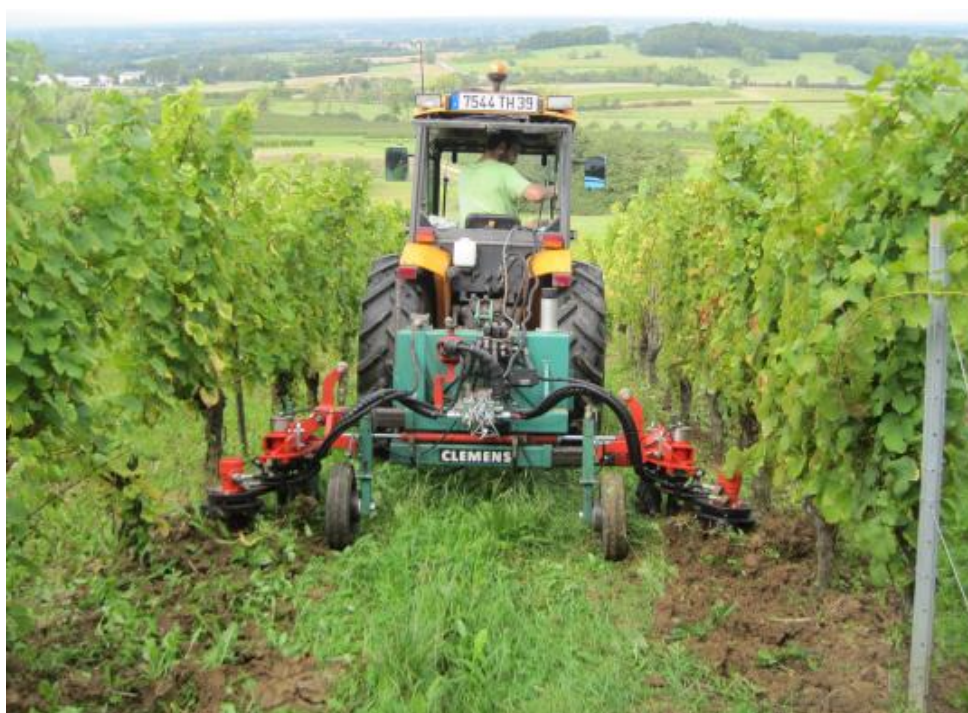
Fig. 2.3 - Operatrice per la lavorazione “intra-ceppo” della ditta Clemens al lavoro in un vigneto.
