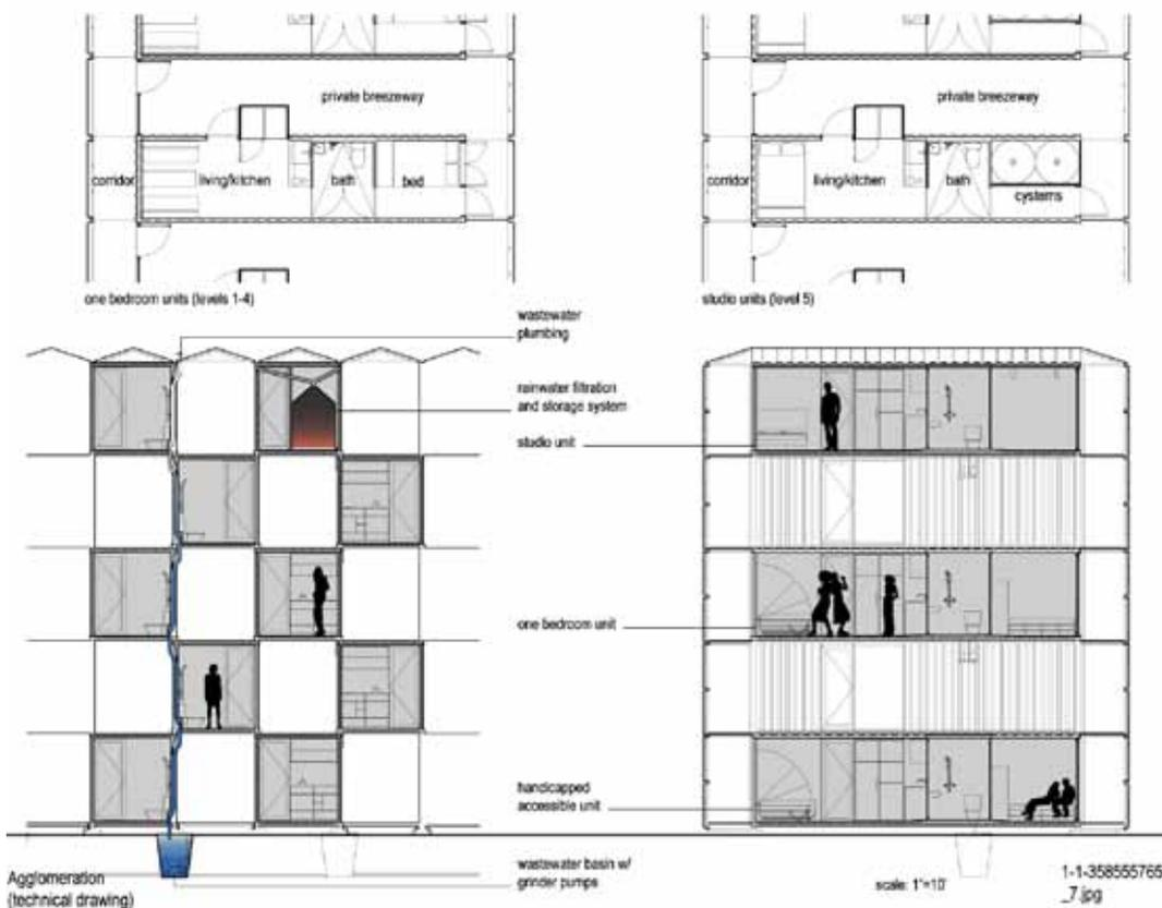
disegni di progetto: piante dei tagli di alloggio, sezione longitudinale con individuazione dell'alloggio tipo e sezione trasversale del sistema in cui è visibile lo schema costruttivo a "scacchiera"
