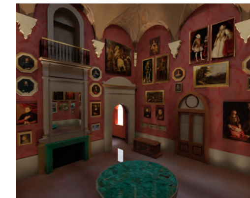
Fotografia 10 Restituzione fotorealistica dell'interno della Sala, ottenuta con simulazione transitoria di commistione tra luce naturale e luce artificiale senza schermatura, per il mese di dicembre alle ore 10- Vista sulle pareti Sud ed Est - Soluzione illuminotecnica proposta.
