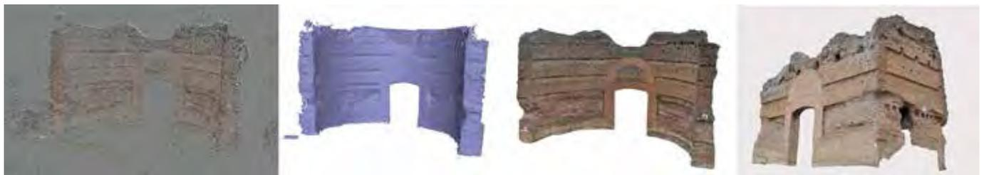
Modello realizzato da rilievo fotogrammetrico. Da sinistra: vista prospettica della nuvola di punti; modello privo di mappatura; modello texturizzato (elaborazione a cura di: P. Pagano, L. Palla, W. Sciaraffa, M. Ventimiglia)
