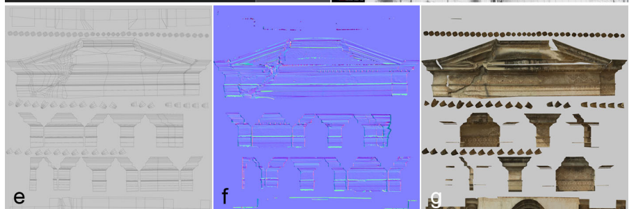
Fig. 6 - a. Calibrazione e idealizzazione della fotocamera; b. bilanciamento del bianco in Adobe Camera Raw; c. Operazione di frecciatura: associazione di punti omologhi tra oggetto rilevato e fotografia; d. proiezione del fotogramma sul modello dalla posizione della camera idealizzata; e. UV map ; f. Normal map ; g. Diffuse color map .
