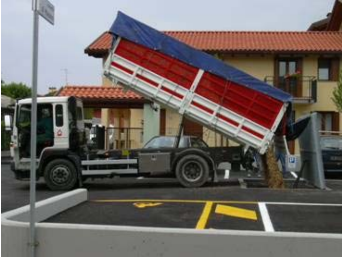
Riempimento del silo per ribaltamento del cassone.
