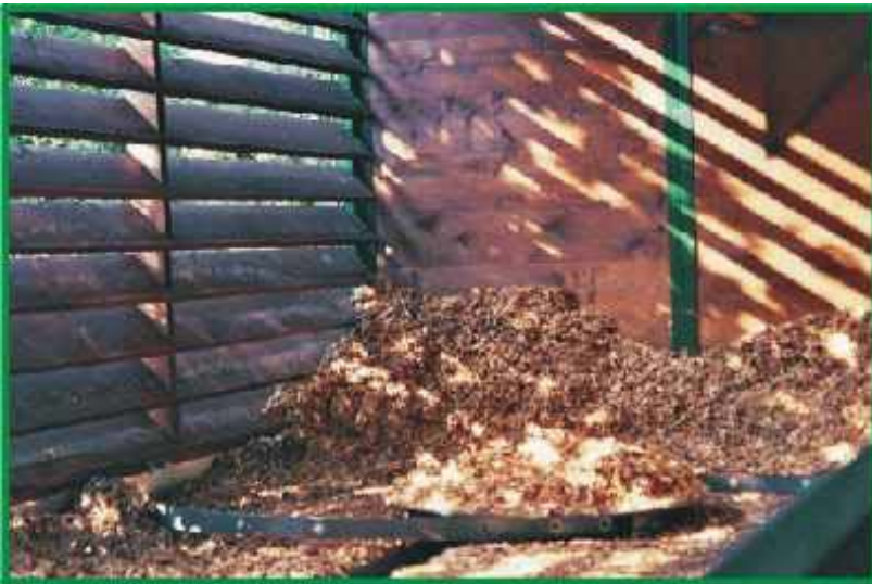
Rotore singolo per estrazione del cippato
