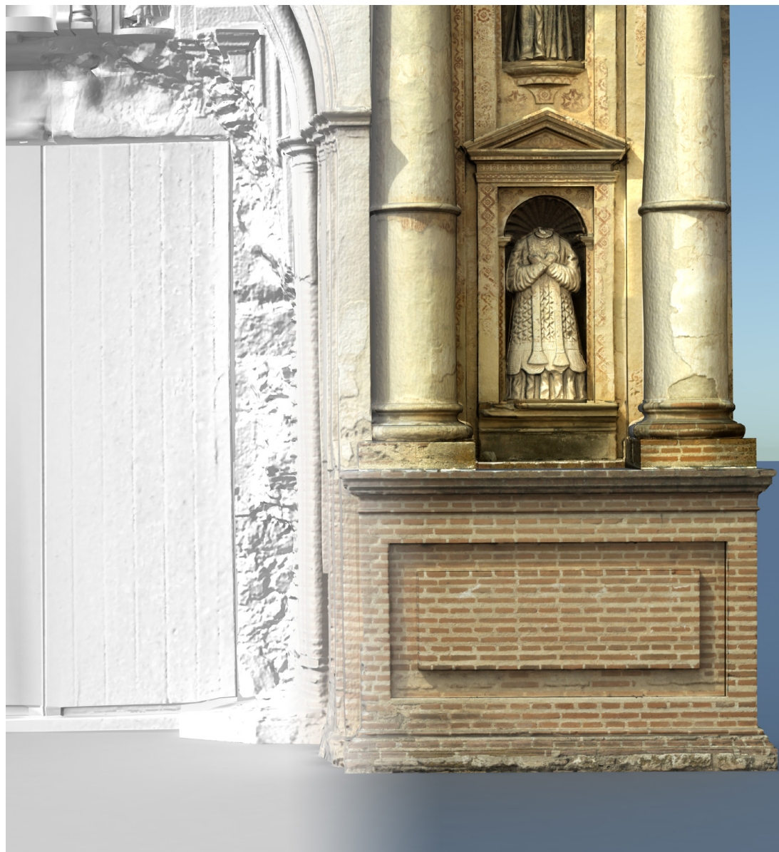
14. Sfolgiato; da sinistra: struttura low-poly del modello ottimizzato, normal map , diffuse color map (dettaglio).
