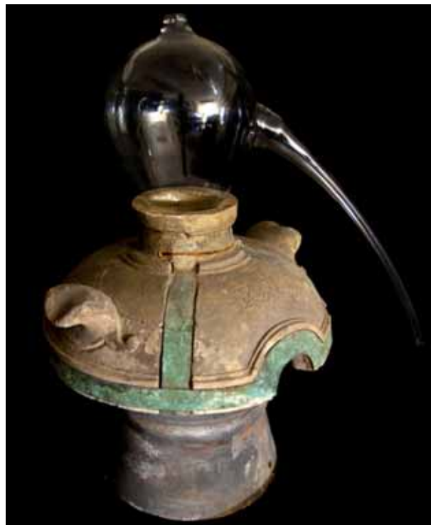
Athamor in terra refrattaria (frammento superiore) con alambicco. Roma, Museo dell'Accademia Nazionale di Arte Sanitaria, inv. 3846°. Foto Baggieri-Bocassini.
