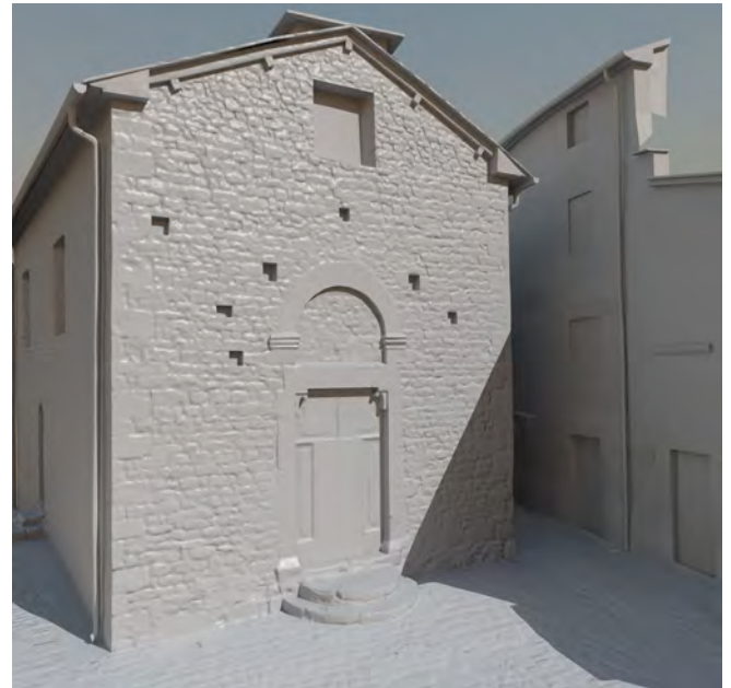
59/ L'oratorio di San Michele: rendering del modello low-poly con l'applicazione di normal map.
