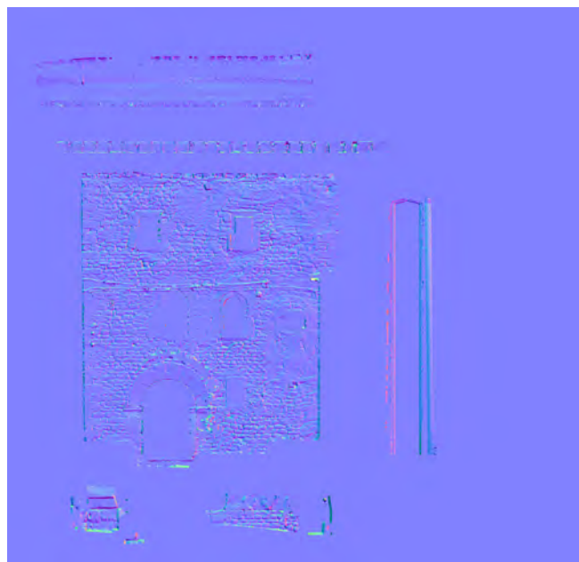
56/ Fronte dell'ex palazzo comunale: la texture delle normali ottenuta mediante baking dal modello high-poly.
