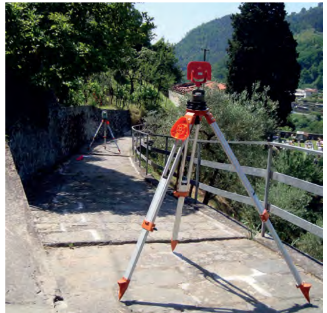
14-15/ Il rilevamento del castello: in alto, un'immagine di una stazione di rilievo laser nelle prossimità di Porta Bolognese; in basso, due stazioni di rilievo topografico.
