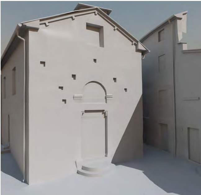
58/ L'oratorio di San Michele: rendering del modello low-poly senza l'applicazione di mappe.
