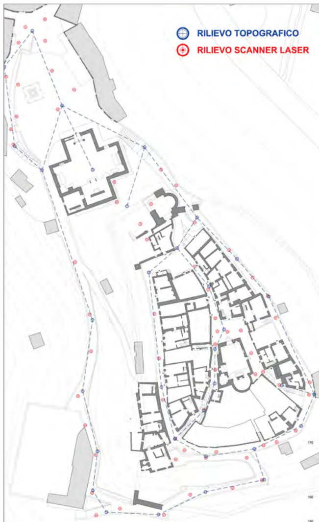
16/ Posizione delle stazioni di rilievo topografico e laser-scanner del castello. Da: A. Merlo, Il castello di Pietrabuona (2012).
