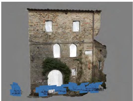
63/ Fasi di lavoro in Photoscan. Sopra: resezione delle fotocamere. Sotto: il modello con texture del colore.
