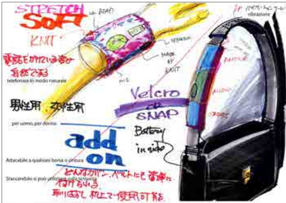
Fig.VI.1.3 - Lo Strip Connector può essere montato sulla tracolla della borsa o indossato come wristband.
