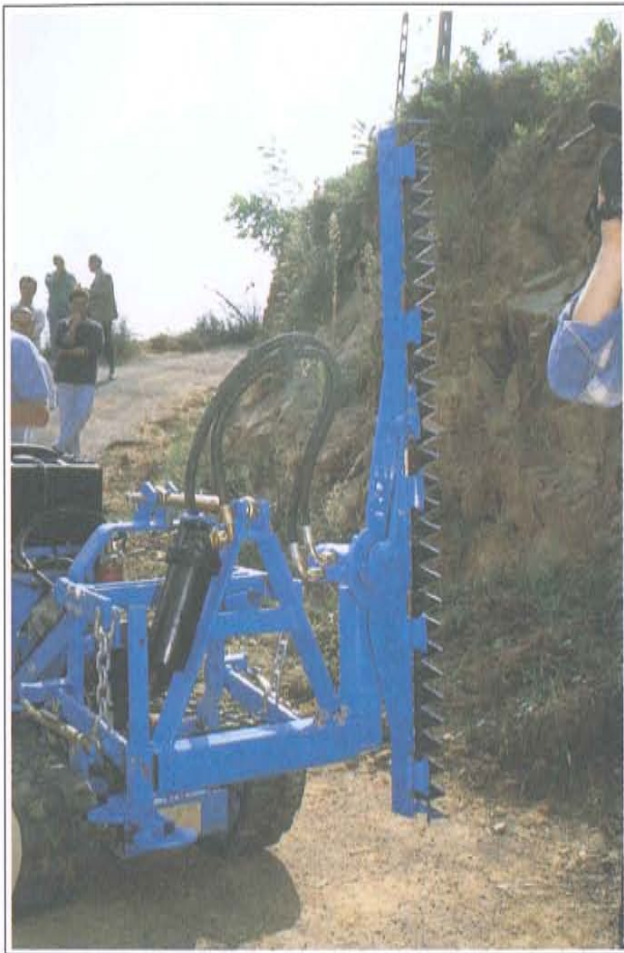
Contrôle de l'herbe par le prototype avec système d'assemblage normalisé.
