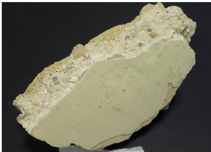
Fig. 22 – Campione stratigrafico di intonaco
