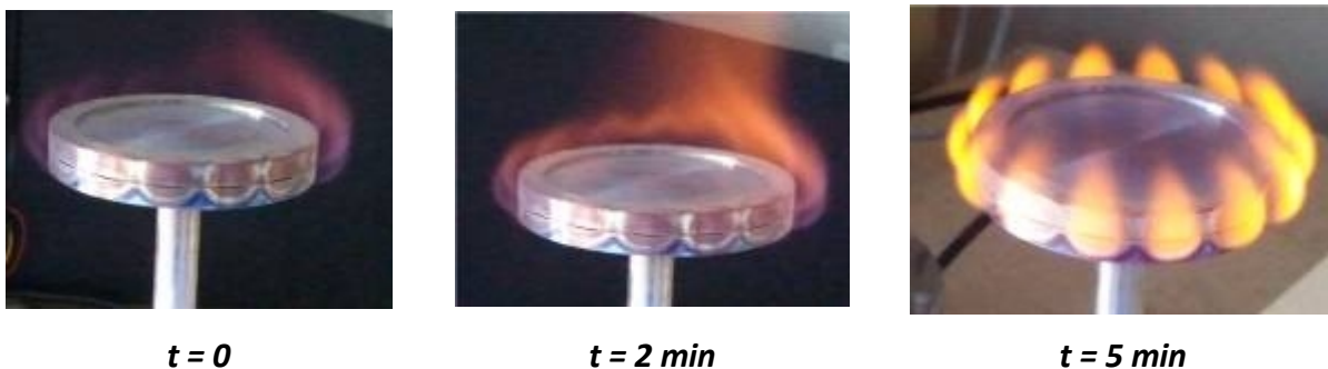
Figura 4.36 – Comparazione della colorazione della fiamma a diversi intervalli di tempo dall'accensione.
