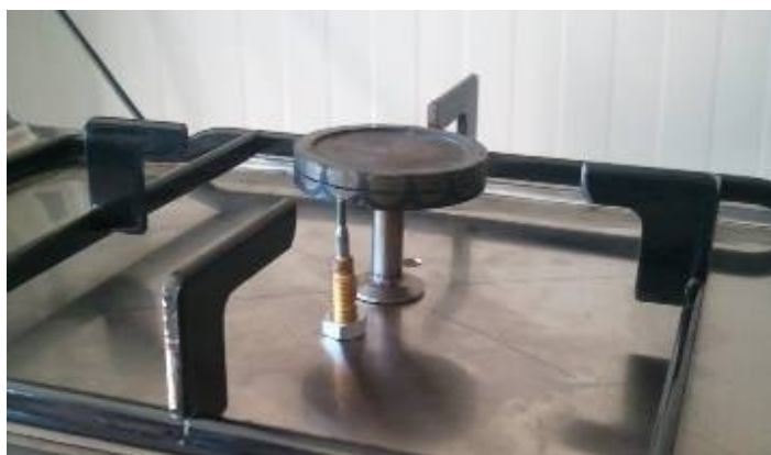
Figura 4.37 – Bruciatore completo installato sul piano cottura
