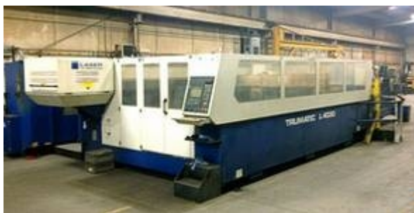
Figura 4.18 - TRUMPF Trumatic L4030, con un laser a CO 2 TLF 4000.
