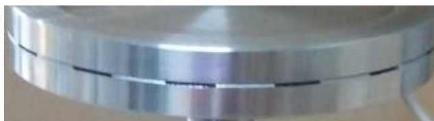
Figura 4.29 – Dettaglio porte del bruciatore
