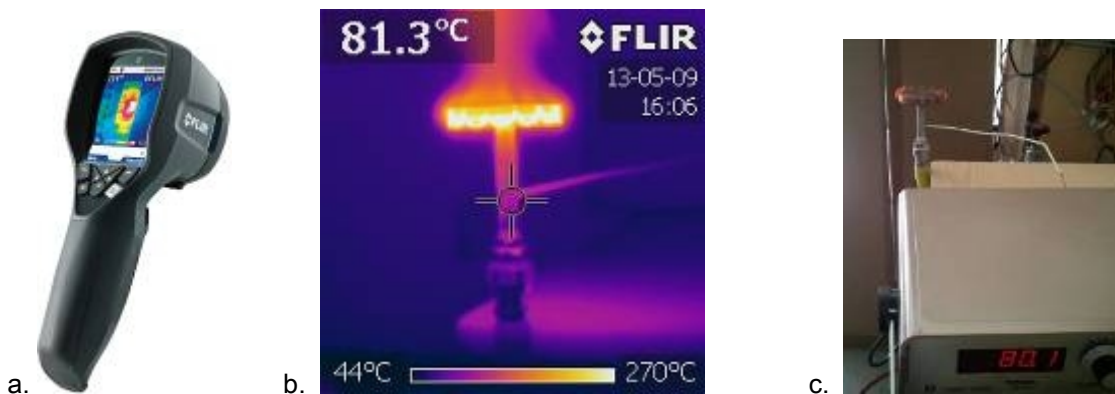
Figura 4.12 – a. Termocamera Flir i7; b-c. Taratura della termocamera con termocoppia K.
