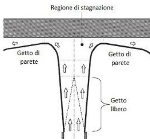
Figura 2.13 – Schematizzazione del getto interno al bruciatore da piano cottura [40].
