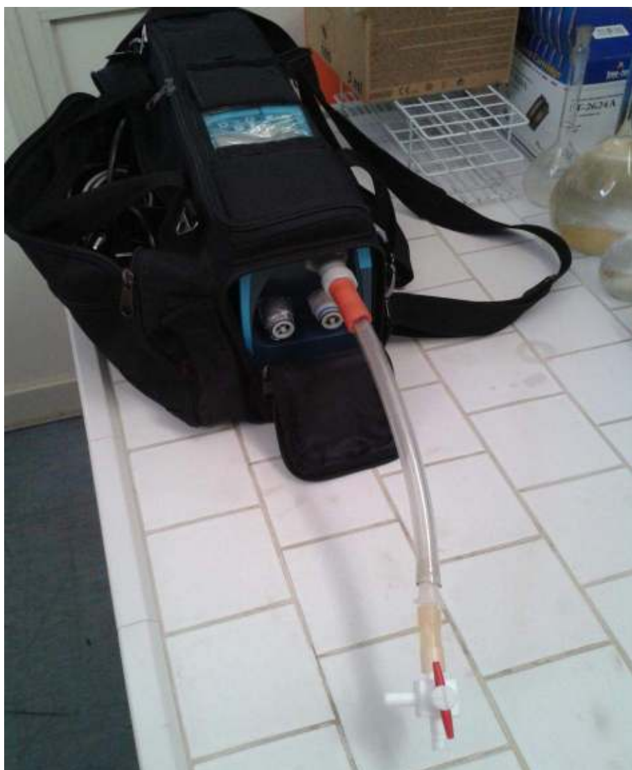
Figura 29. Tubo in plastica e rubinetto a 3 vie connessi direttamente al Lumex, per facilitare la procedura di iniezione.
