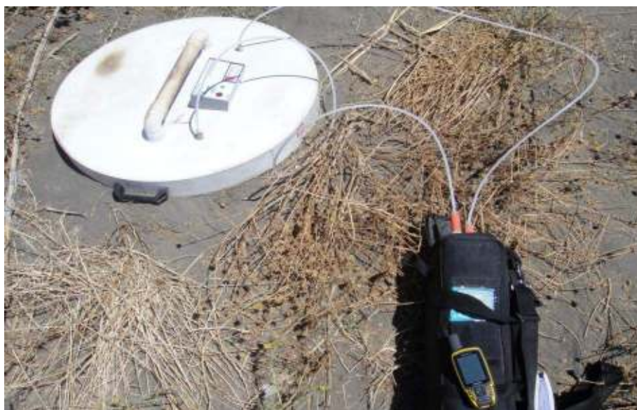
Figura 25. Geometria adottata per la misura dei flussi di \text{Hg} , rappresentante il Lumex connesso alla camera di accumulo in un circuito chiuso. Modificata da Cabassi et al. (2014).
