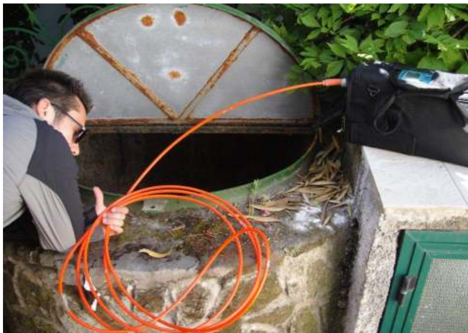
Figura 32. Lumex connesso ad un tubo Rilsan per la misura della concentrazione di Hg^0 all'interno di pozzi caldi.
