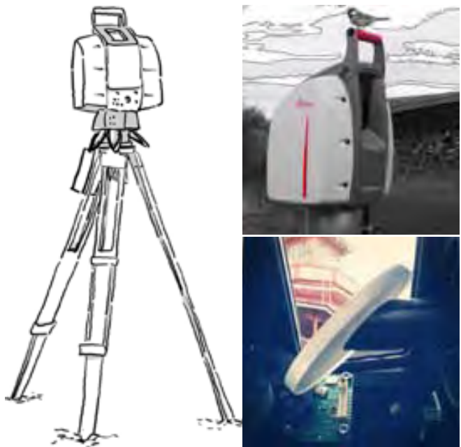
Laser scanner Leica ScanStation 2. Particolare del sistema di specchi moventi per la riflessione dell'impulso laser.
