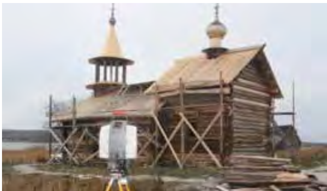
Le operazioni di rilievo nel villaggio di Vasilevo e la nuvola di punti colorata con le immagini acquisite dallo scanner. Le lacune dovute alle impalcature per i lavori di restauro della cappella sono state colmate attraverso operazioni di fotoraddrizzamento e misurazioni dirette.
