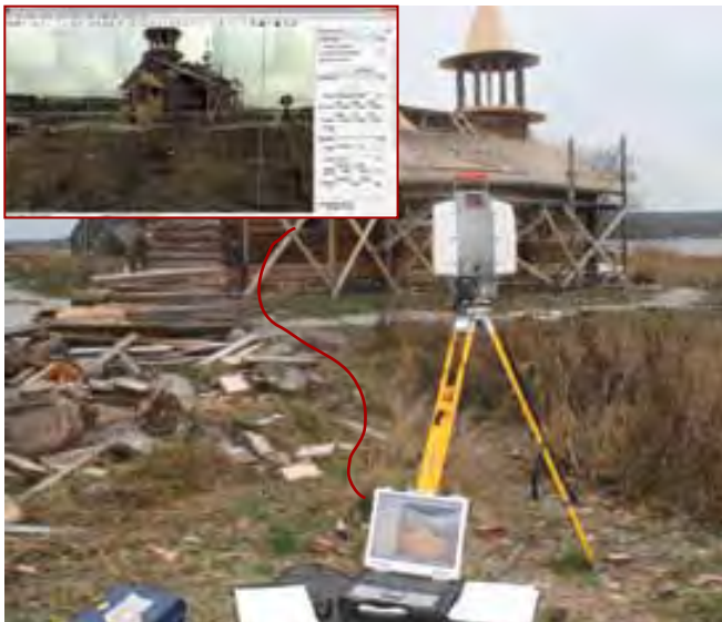
Il laser scanner a lavoro nel villaggio di Vasilievo. La scansione viene impostata direttamente dal pc, regolando di volta in volta i parametri di acquisizione dei dati.
