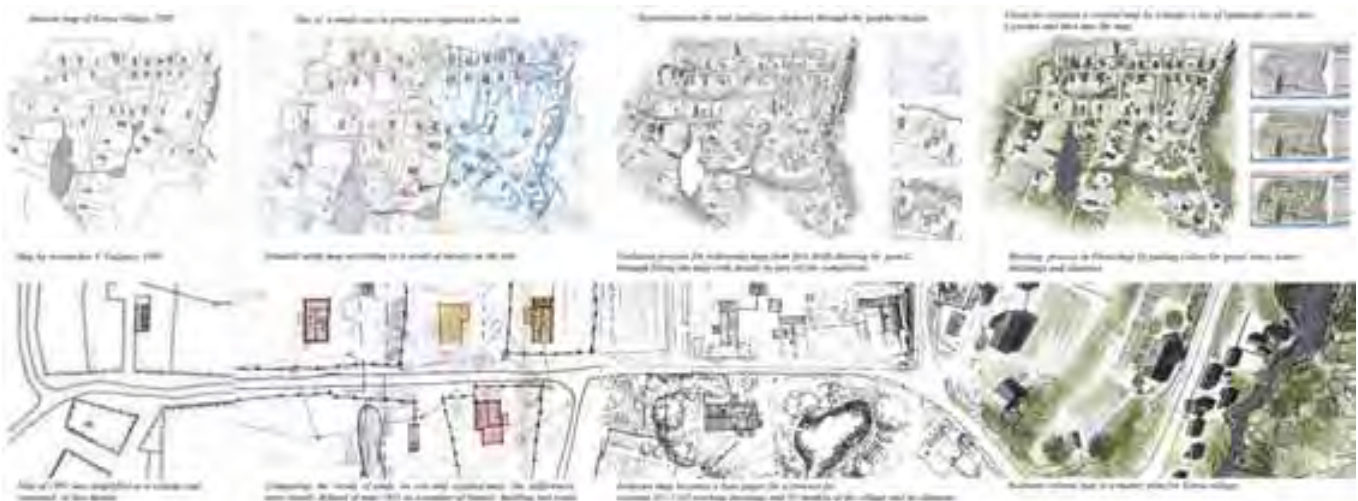
Metodologia di analisi e confronto del materiale cartografico reperito sul villaggio storico di Korza. La carta del 1909 individua esclusivamente lo schema insediativo. Nella mappa del 1991 i dati riguardano l'individuazione dei percorsi, del costruito e dei confini di proprietà.
