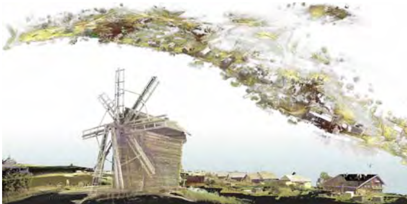
Viste generali della nuvola di punti del villaggio di Yamka dell'Isola di Kizhi. La colorazione della nuvola è fondamentale per l'ottenimento delle migliori visualizzazioni in base alle diverse necessità (viste generali per il contesto, immagini di dettaglio per il ridisegno tecnico).
