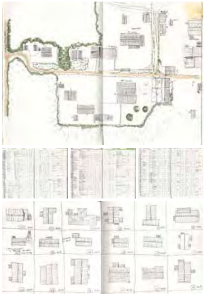
Ridisegno a vista delle prime planimetrie di studio, codifica delle unità edilizie corrispondenti ad ogni singola costruzione, compilazione della scheda e ridisegno dei sistemi di copertura per l'analisi della volumetria esterna.
