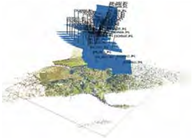
Nuvola di punti del villaggio di Shuknavolok in ambiente Photoscan (software di Agisoft) con individuazione dei punti di ripresa dall'alto.
