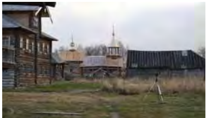
Le operazioni di rilievo nel villaggio di Vasilevo e la nuvola di punti colorata con le immagini acquisite dallo scanner. Le lacune dovute alle impalcature per i lavori di restauro della cappella sono state colmate attraverso operazioni di fotoraddrizzamento e misurazioni dirette.
