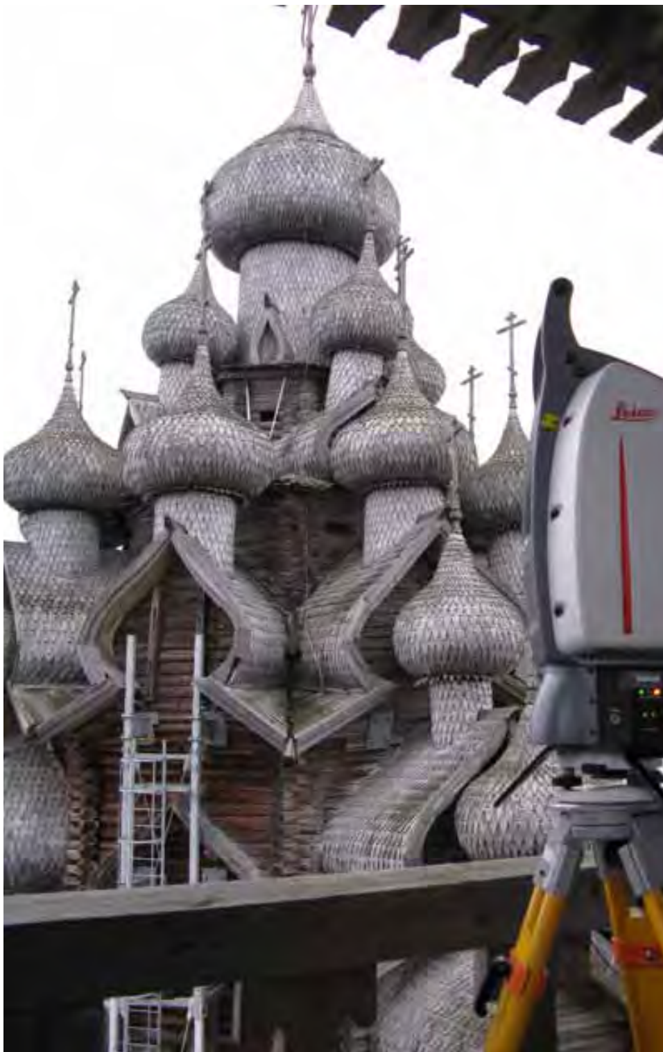
Immagine tratta dalla campagna di rilievo laser scanner per lo studio del complesso della Pogot e nello specifico per la documentazione della Chiesa della Trasfigurazione, patrimonio UNESCO che si trova nella parte sud dell'isola di Kizhi in Carelia. Il rilievo e le elaborazioni 2D e 3D di questo monumentale sono stati il tema di tesi della laurea magistrale quinquennale in Architettura sostenuta nel Luglio 2011.
