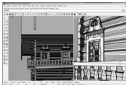
Immagini delle fasi di elaborazione del modello tridimensionale della struttura architettonica di un'abitazione in legno dai disegni CAD 2D.
