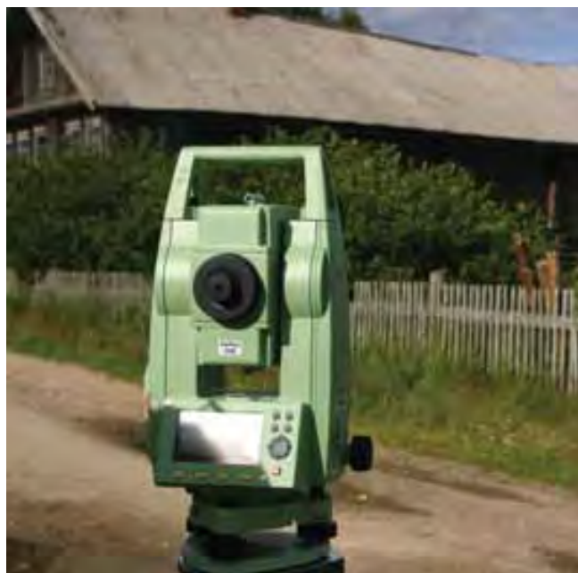
La stazione totale a lavoro. Per il rilievo del villaggio lo strumento è stato posizionato lungo i percorsi stradali principali.
