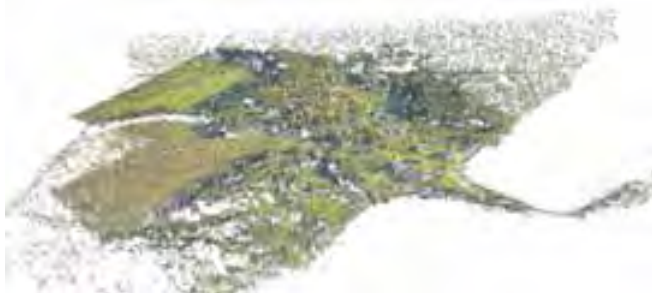
Nuvola di punti del villaggio di Shuknavolok in ambiente Photoscan (software di Agisoft) con individuazione dei punti di ripresa dall'alto.
