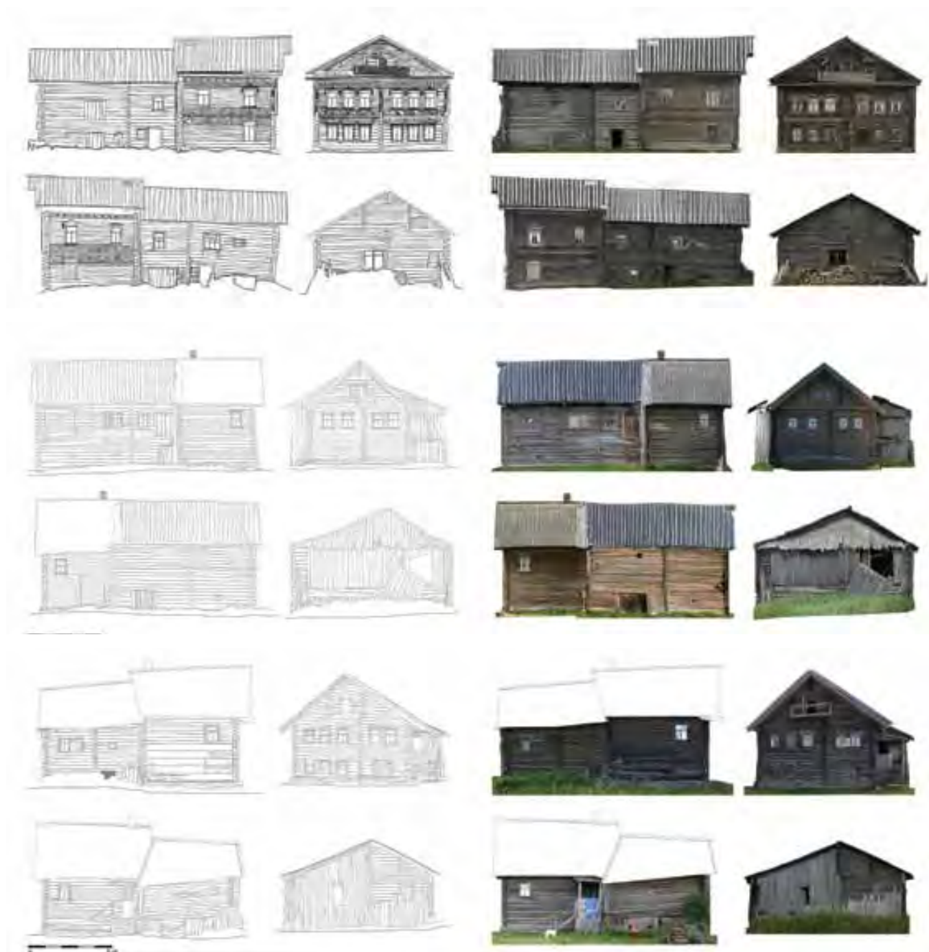
Unità edilizie del villaggio di Bolshaya Selga nella provincia di Olonets. Ogni abitazione presenta un doppio volume che sottolinea la diversità degli ambienti con funzione residenziale da quelli destinati ai magazzini ed alle stalle. I disegni, che riportano i rilievi dei fronti principali dell'unità edilizia, espongono un confronto tra restituzione grafica a fil di ferro e restituzione materica attraverso l'utilizzo del fotopiano.
