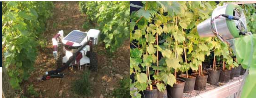
Qui a fianco, il robot francese della Wall-Ye e, più a destra, il braccio robotizzato del progetto CROPS per il trattamento localizzato
