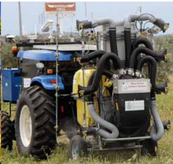
◀ Robot CNH con sistema irrorante dell'Università di Firenze impiegato nel progetto Rhea
