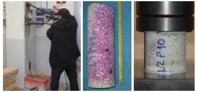
Figura 11. Da sx verso dx: estrazione carota in situ, prova di carbonatazione e prova a compressione in laboratorio.
