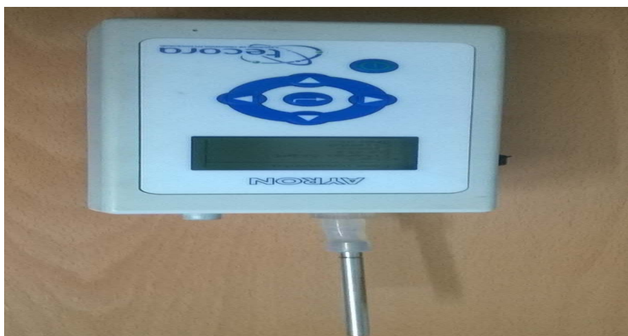
Figura 2.11 - Sistema di campionamento trappola ST con pompa portatile
