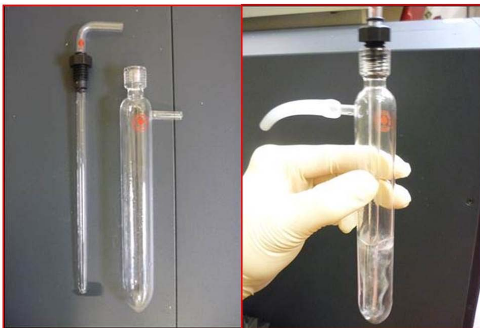
Figura 2.18 - Dettaglio del Gorgogliatore utilizzato per cattura e trasferimento del gas nella trappola : a) contaminanti metallici e metalloidi in trappola acida b) Solfato per analisi isotopi dello S in trappola basica.
