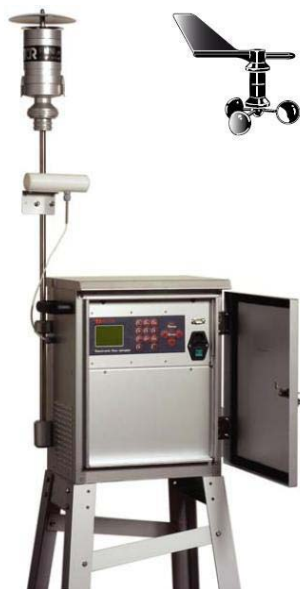
Figura 2.3 - Campionatore per particolato atmosferico TECORA (ECHO PM Ambient Sampler) con testa LVS PM10 2.3 m 3 /h.
