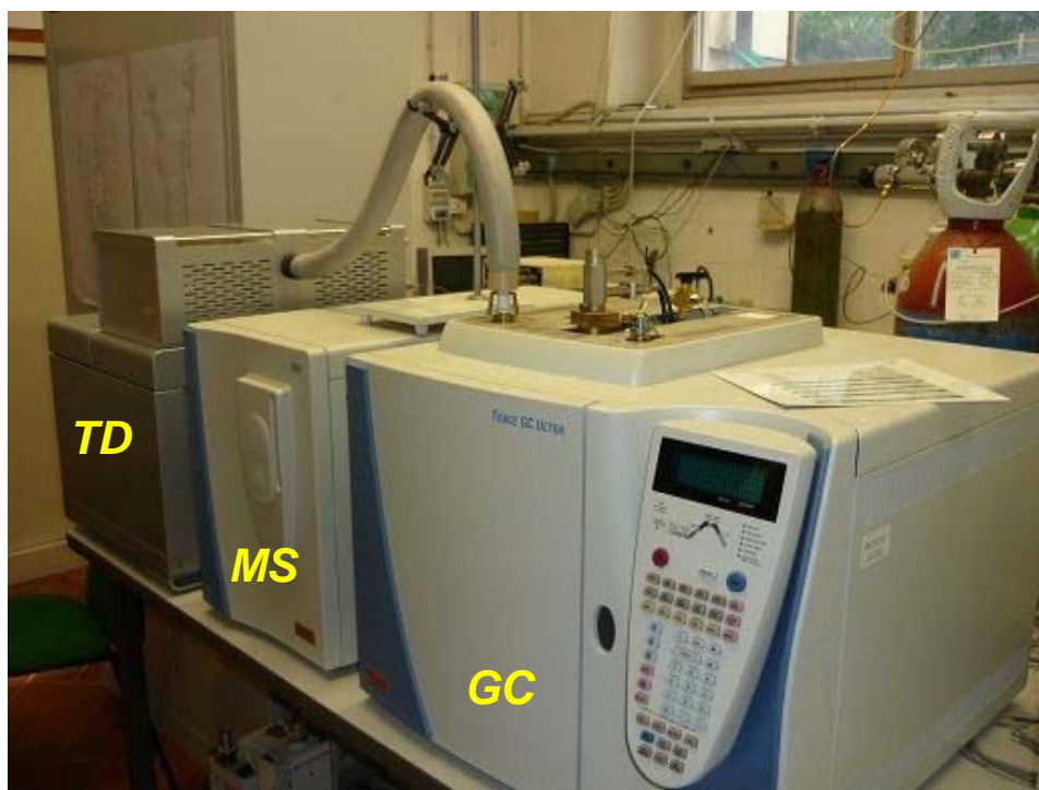
Figura 2.9 - GC-MS Thermo Trace GC Ultra accoppiato con desorbitore termico DANI Master TD e rivelatore a spettrometro quadrupolare Thermo DSQ.
