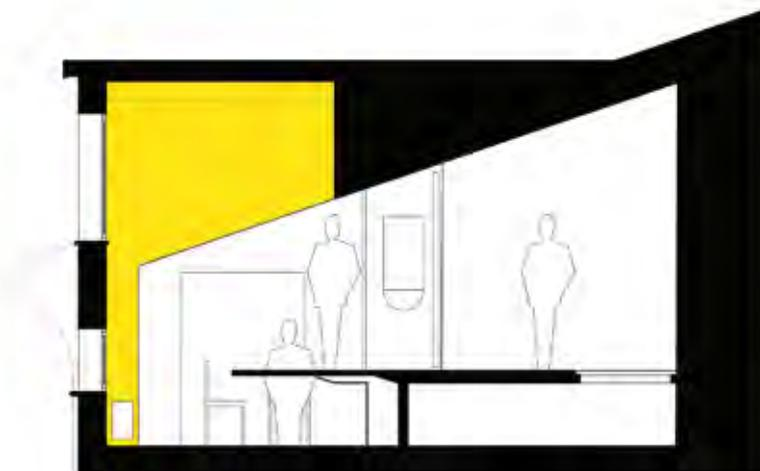
Figg. 90 - 93 Michele Bonino (MARC), Subhash Mukerjee (MARC), Federica Patti, Martina Tabò (maat architettura), Massimo Piano Orizzontale, Appartamento a Torino, 2000. In questo recupero di un sottotetto, la necessità tecnica di un intervento di consolidamento strutturale, che alza il livello di calpestio di una parte dell'abitazione di 72 cm, si traduce in un sistema di piani a sbalzo verso la parte più bassa, che ospita il tavolo, il piano della cucina, rampe di accesso.
