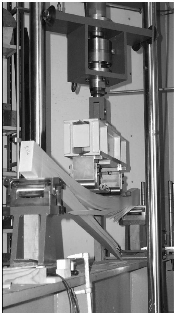
Figure 3. Prova di flessione statica, secondo la norma EN408.
