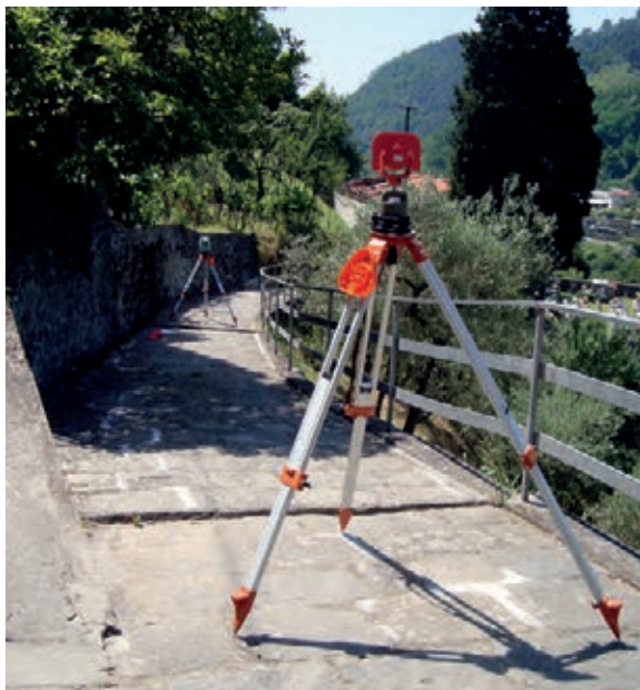
Fig. 2 - Stazione totale Leica TPS di tipo no prism
