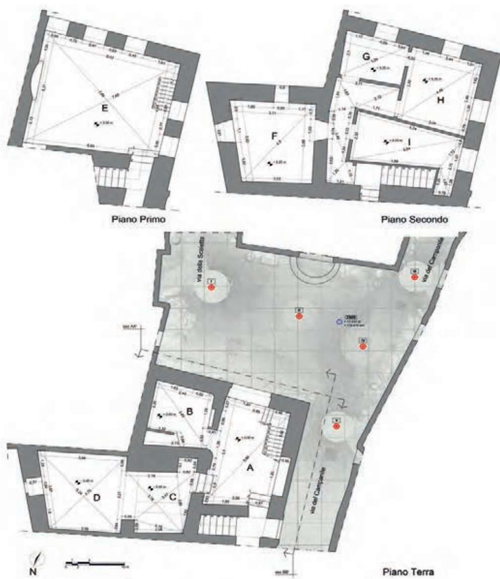
Fig. 4a - Il rilievo integrato del palazzo pubblico - piante (elaborati a cura di Gaia Lavoratti e del gruppo spagnolo coordinato da Pablo Rodriguez Navarro)
