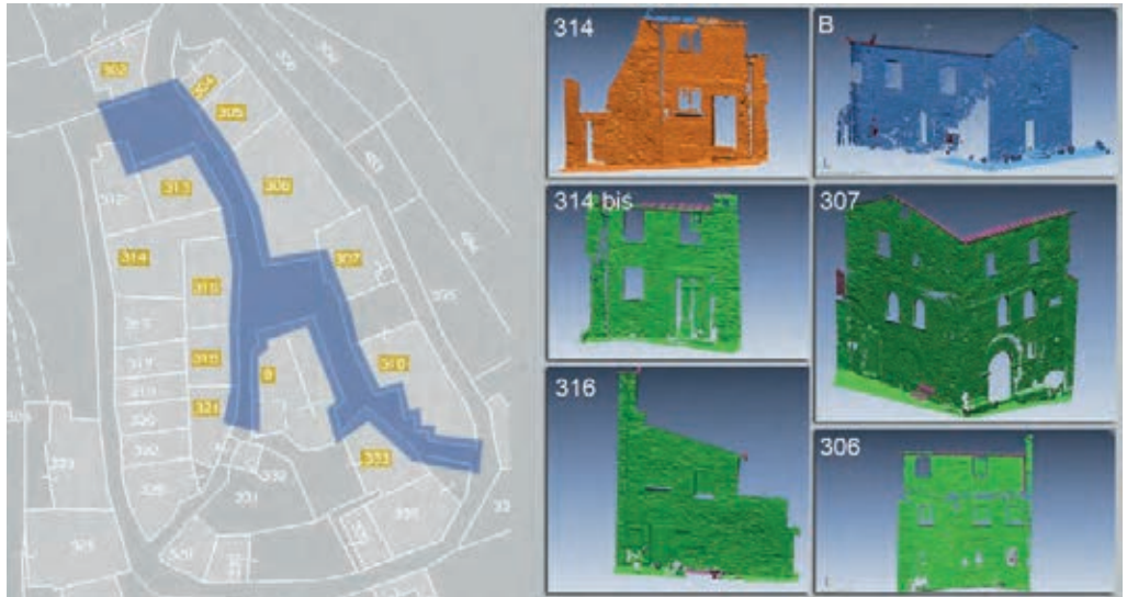
Fig. 3 - Data l'estrema pesantezza della mole di dati acquisita con la campagna di rilevamento scanner laser si è deciso di suddividere il modello a nuvola di punti in varie "fence" che, esportate separatamente, permettono un maggiore controllo della fase di costruzione delle mesh ad alta risoluzione
