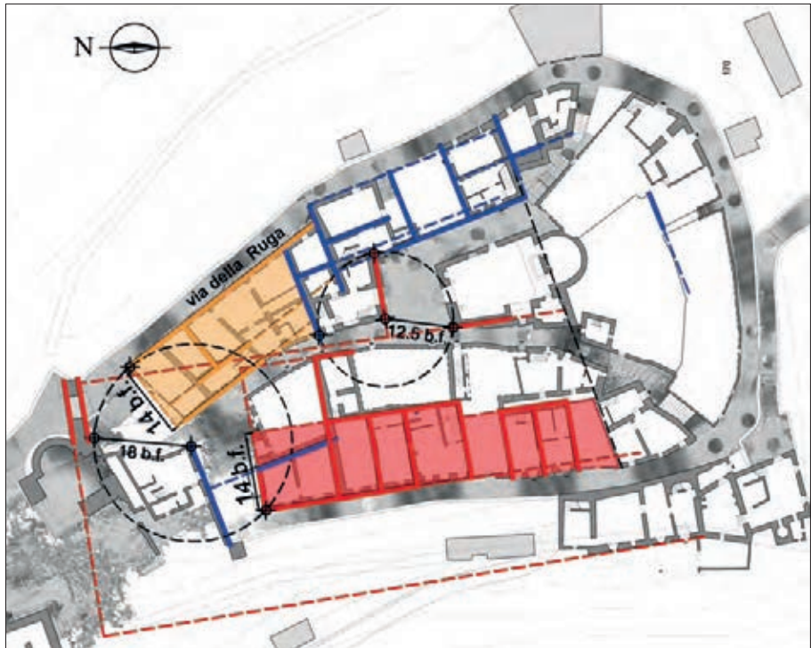
Fig. 6 - L'ampliamento trecentesco dell'abitato. Le nuove stecche di edifici (in rosso ed arancione) presentano una profondità pari a 14 braccia fiorentine (8,17 metri), ma una diversa tipologia edilizia. In blu la direzione delle murature portanti degli edifici presumibilmente costruiti a completamento del primitivo nucleo fortificato
