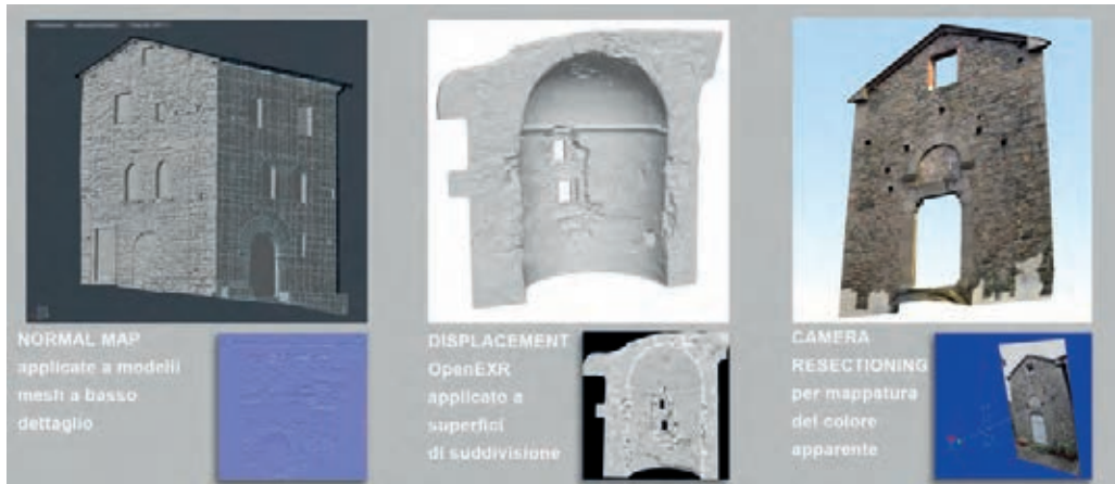
Fig. 2 - Le tre tecniche di Image Based Geometric Processing che permettono in modo diverso di migliorare la percezione di modelli semplificati grazie all'impiego di texture
