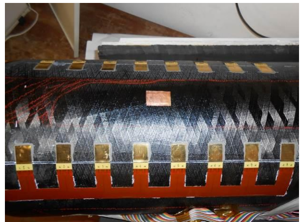
Figura 5: COPV con patch adesiva che simula un difetto superficiale.
