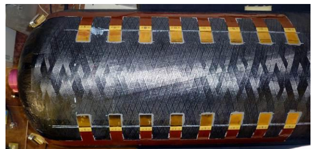
Figura 1: COPV con trasduttori montati ed interconnessi.
