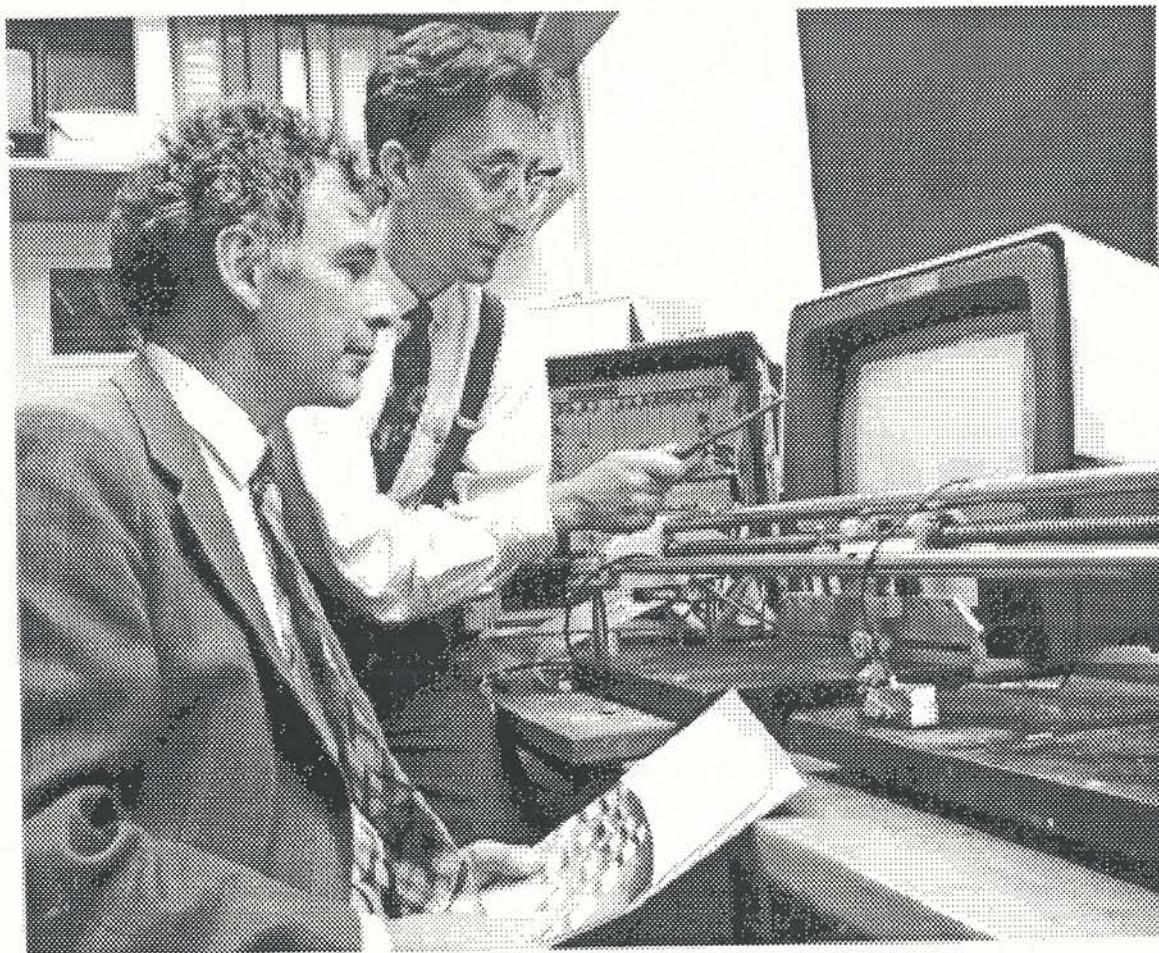
Figura 1.5. Sistema di classificazione in linea basato sul sistema di acquisizione ed elaborazione dati ultrasonici ZIPSCAN. Una sonda a contatto sul blocco con saldatura a V e' mostrata in basso a destra.
