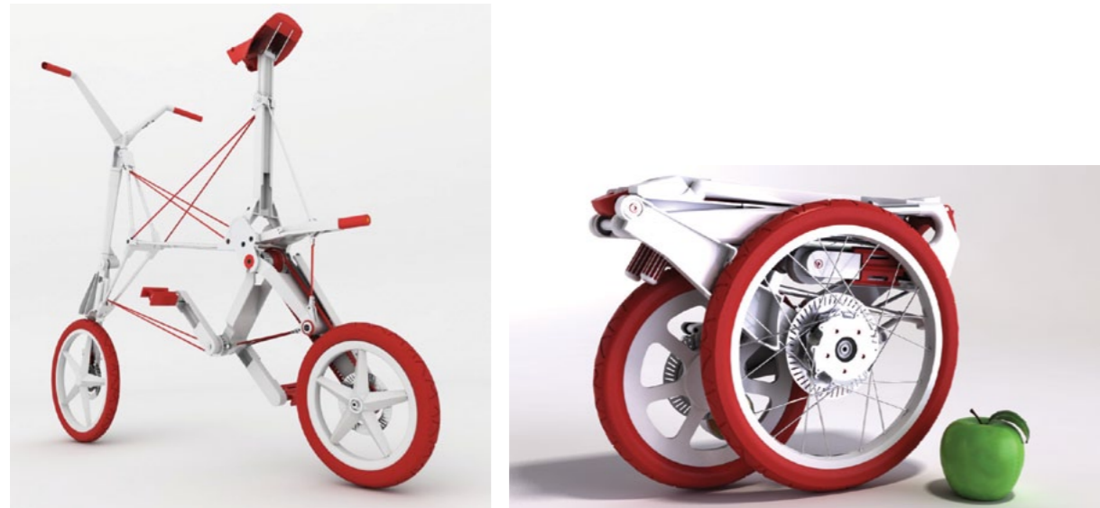
Fig. 1-2 Prototipo della bicicletta pieghevole, aperta e richiusa.
