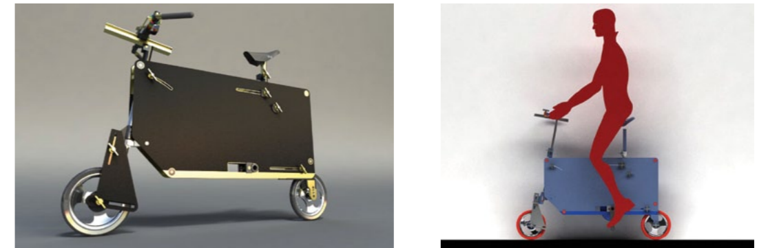
Fig. 5 Strumento di misurazione: realizzato e messo a punto per gli studi posturali. Le distanze tra i vari componenti sono regolabili e hanno permesso la validazione dei risultati emersi in fase di valutazione ergonomica.
