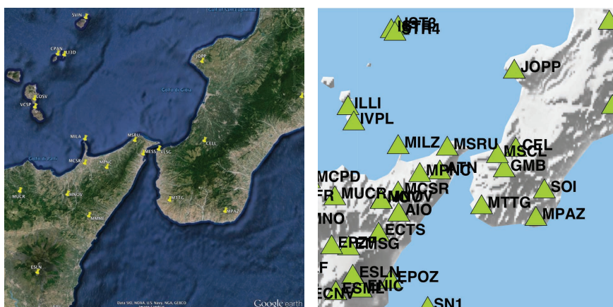
Fig. 2. La distribuzione delle reti geofisiche permanenti dell'INGV nell'area dello Stretto di Messina: ricevitori GPS (sinistra), per la misura della deformazione del suolo; siti della rete sismica (destra).
