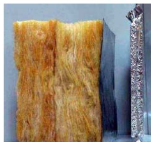
Fig. I.5 Pannello VIP confrontato con lana minerale: i due materiali hanno eguale resistenza termica.
