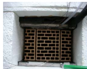
Fig. I.69. Apparato di misura per blocchi termici
