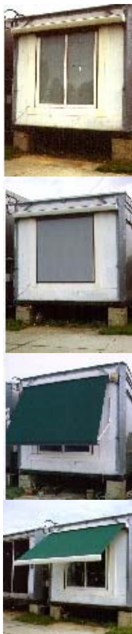
Fig. I.37. Prove su test cell di schermature esterne su facciata esposta a sud. Credits: PASSLINK
