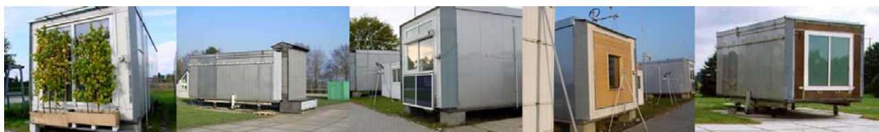
Fig.I.167. Fotografie di camere di prova all'aperto realizzate con i programmi PASSYS e PASLINK in vari paesi Europei.
