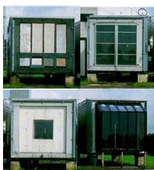
Fig. I.46. Quattro test cell a confronto per misurare diversi elementi di facciata. Dall'alto a sinistra e in senso orario: 4 elementi fotovoltaici di natura diversa; componente trasparente con infisso; componente opaco in c.a. con finestra; piccola serra solare e conseguenti effetti sulla test cell. Credits: G. Flamant.
