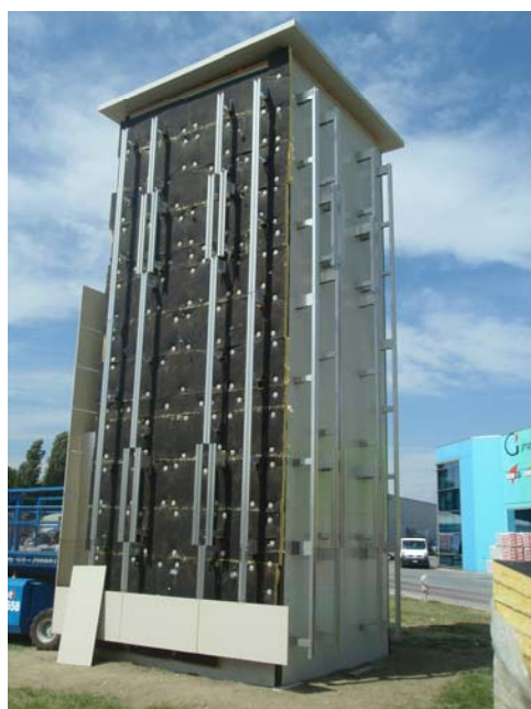
Fig. I.58 e I.59. Immagini del montaggio della parete ventilata sulla camera di prova. Credits: C. Marinosci
