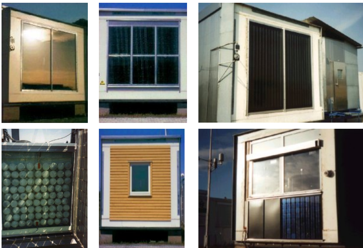
Fig.I.106. Immagini di alcuni componenti testati presso BTU. Dall'alto verso destra: componenti vetrati specchiati, fotovoltaico in facciata, solare termico in facciata. In basso: PCM, sistema componente opaco-finestra, diversi tipi di fotovoltaico a confronto. Credits: PASLINK
