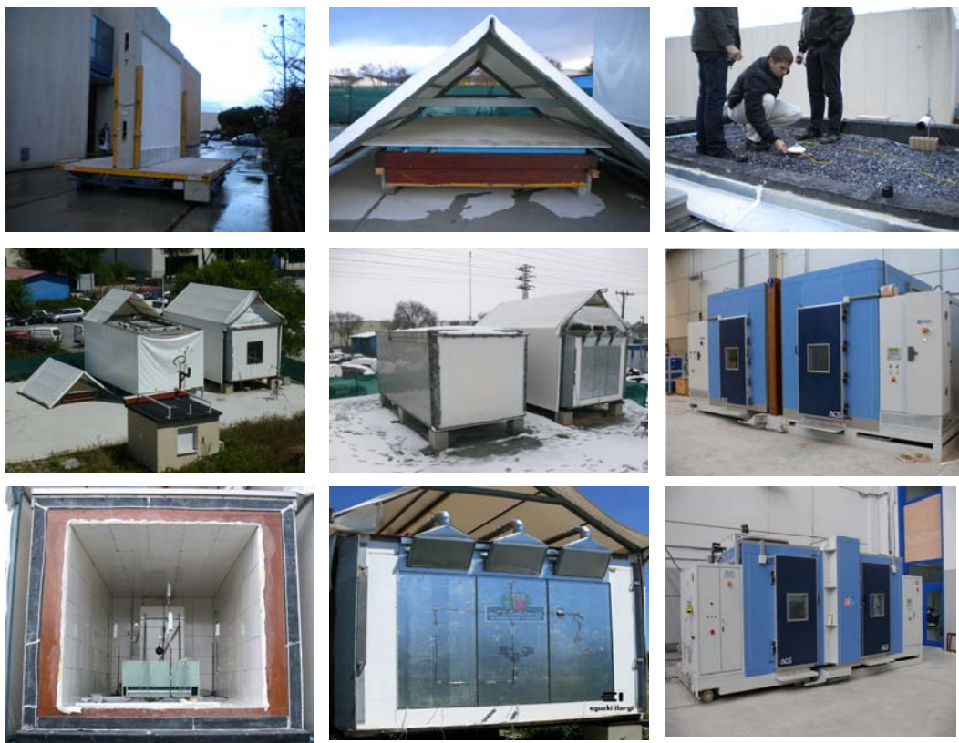
Fig. 1.82. Dall'alto a sinistra. Muro da testare, posizionato su piattaforma su binari, dal laboratorio di costruzioni fino al test site. Tetto rimovibile. Posizionamento strumentazione su copertura piana. Nella riga centrale. Vista del test site a primavera e in inverno. Guarded hot-box per le misure su componenti vetrati. In basso. Vista della test cell senza il muro da testare. Parete ventilata. Guarded hot-box per test in regime stazionario di pareti opache. Credits:G. Alcamo, I.Flores
