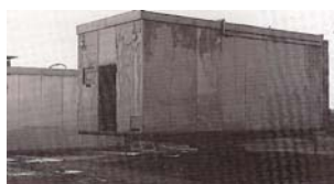
Fig. I.55 Test cell su base girevole e con tetto removibile, realizzata con il progetto Roof-Soil nel 1996.
