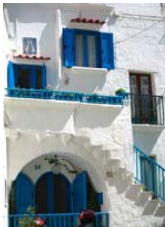
Fig.I.131. Esempio di architettura in clima Mediterraneo. Costruzioni massive, piccole finestre, balconi, loggiati, facciate di colore chiaro, sistemi di protezione solare esterna. Santorini. Credits: M. Sala
