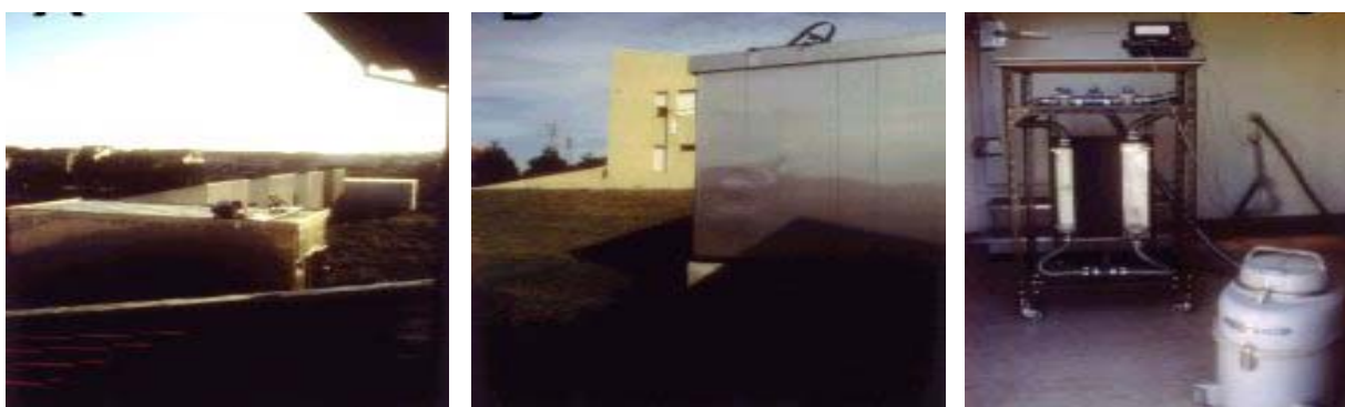
Fig.I.103. Immagini del test site a Porto. Le celle con il progetto PASSYS sono state modificate per migliorare le prestazioni e condurre misure anche nel periodo estivo. Sono quindi state equipaggiate con strumentazione per le misure sulla radiazione solare, sulle infiltrazioni ed è stata realizzata una test cell con tetto removibile. Credits: PASLINK.
