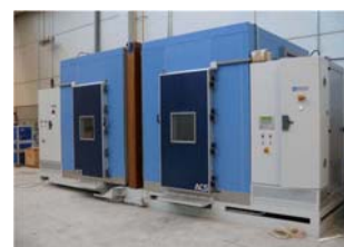
Fig. 1.9. Hot-box per misure in regime stazionario: in alto per le misure su componenti opachi, in basso per le misure su componenti finestrati. Vitoria, Spain.
