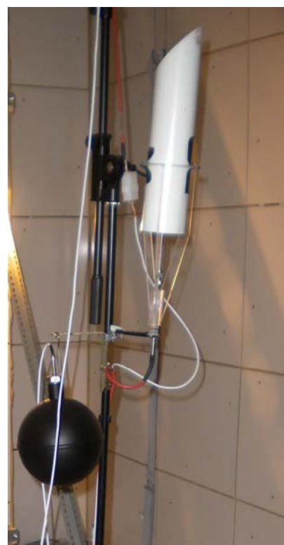
Fig.II.68. PT100 con schermatura solare cilindrica bianca, per misurare la temperatura in prossimità delle pareti verticali. Credits: G. Alcamo
