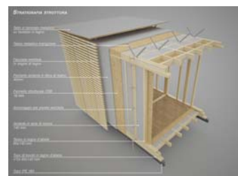
Fig. II.1 Vista in spaccato assometrico del progetto proposto della test cell.
