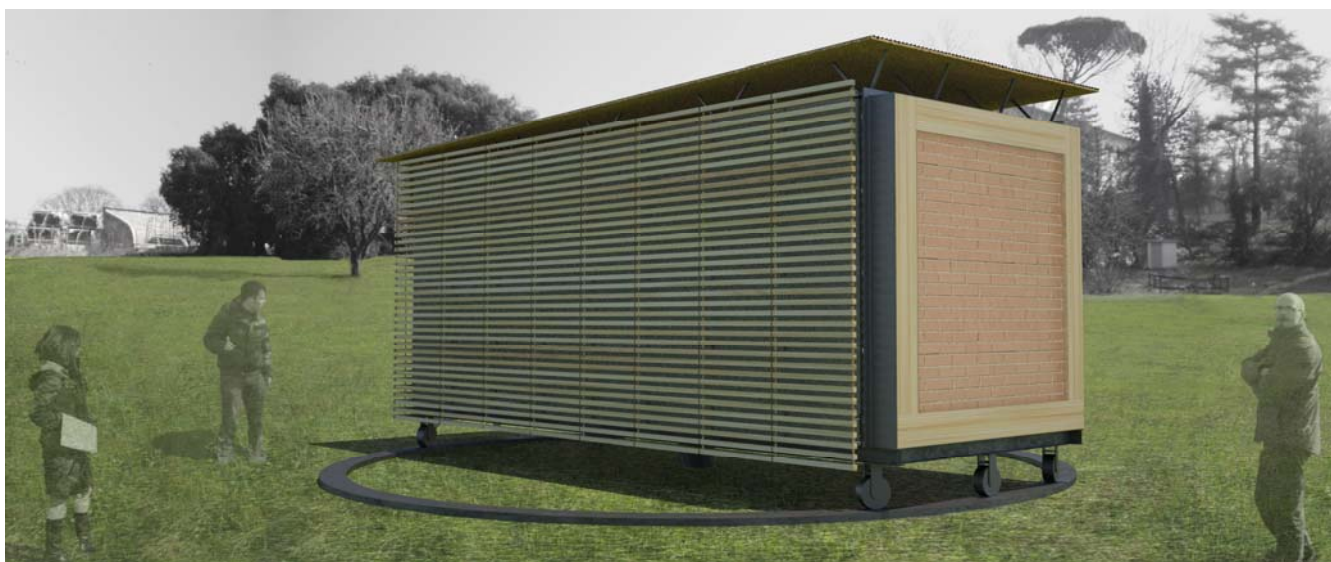
Fig. II.41 Componente di prova opaco: muratura massiva in blocchi di laterizio.
