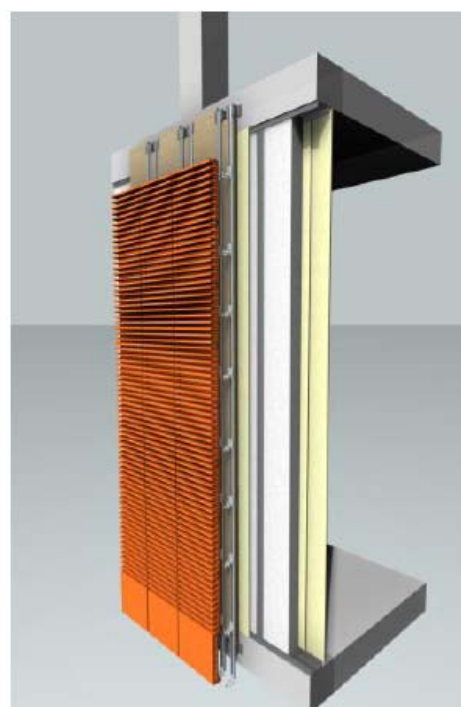
Fig. II.45. Spaccato assometrico dello Shading Screen Credits: M. Villalta
