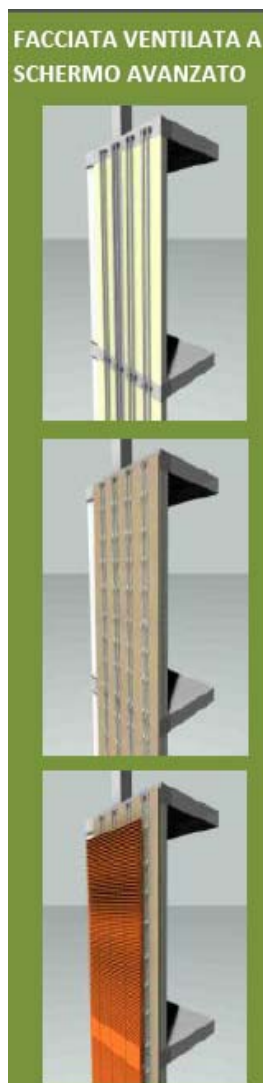
Fig. II.44. Shading Screen: Sistema di facciata ventilata a schermo avanzato. Tesi di Dottorato Arch. M. Villalta. Il progetto sta per essere realizzato da Palagio Engineering in collaborazione con Cotto Impruneta. Credits: M. Villalta
