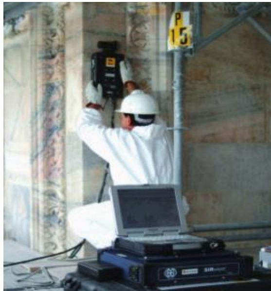
Figura 2 – Utilizzo del GPR in indagine strutturale
