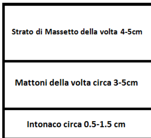
Figura 26 – Ipotesi (dei restauratori) sulla stratificazione della volta
