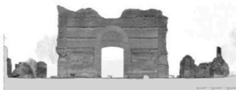
Figura 2. Restituzione di un fotopiano dell'area di palazzo realizzato con metodologie integrate Laser scanner 3D e fotogrammetria digitale.
