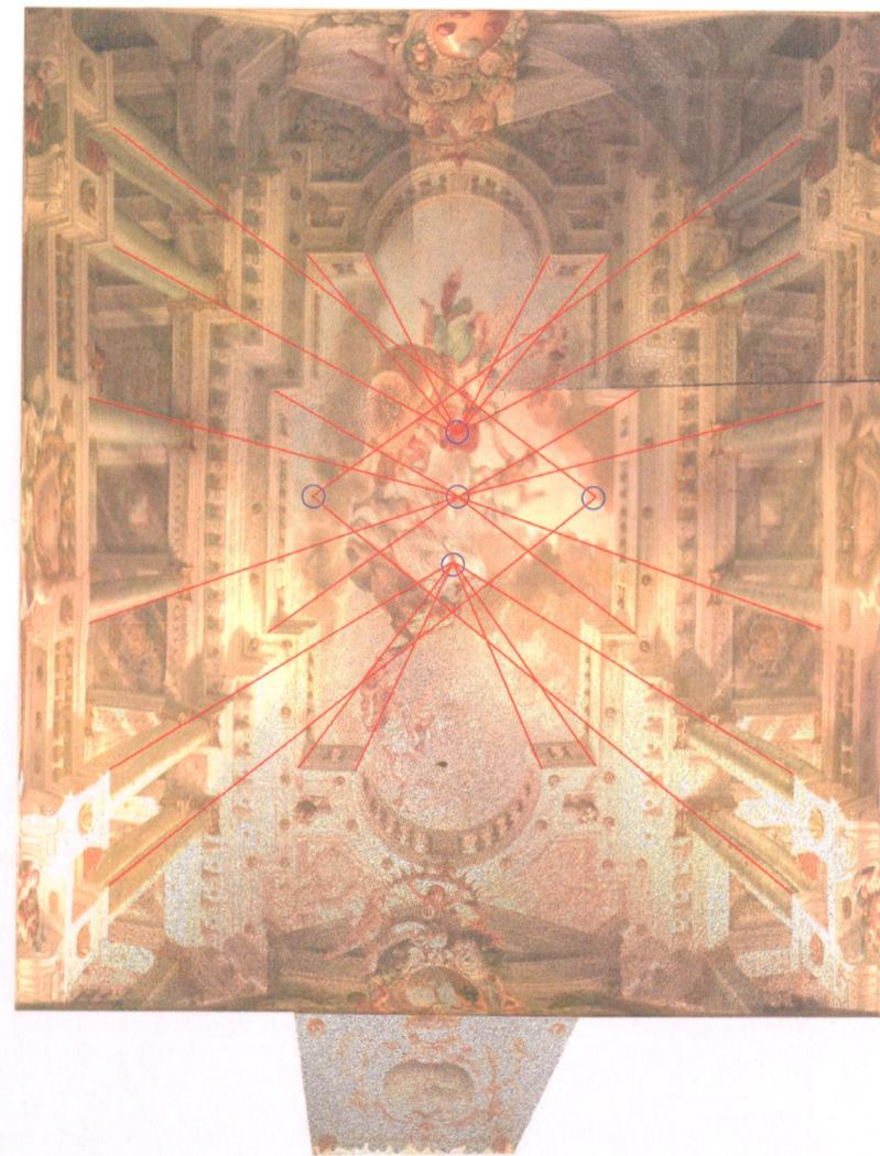
Figura 2 - Restituição da seção da imposta da abóbada com visão perspéctica da decoração do teto, da sala de Audiência Privada, parte do atual Museo degli Argenti do Palácio Pitti, em Florença. Através deste tipo de restituição é possível estudar o efeito visual do programa geométrico da arquitetura pintada sobre a abóbada. Neste caso, se evidencia a aplicação de um sistema perspéctico com mais pontos focais.
