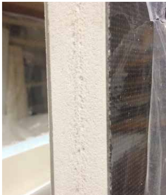
(Immagine n. 133a) Dettaglio della fiancata con fibra di basalto (fase di prototipo)
