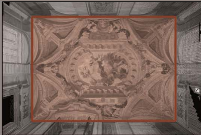
Proiezione conica delle nuvole di punti di una sala dell'Appartamento dei Granduchi, Pisa
