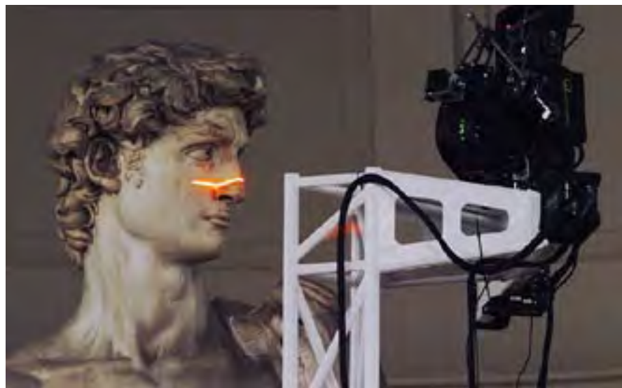
Fig. 20/21 - The Large Statue Scanner , lo scanner laser appositamente approntato dalla Cyberware per l'Università di Stanford per i rilievi eseguiti nell'ambito del Digital Michelangelo Project . Veduta di insieme e particolare dell'unità di acquisizione.
