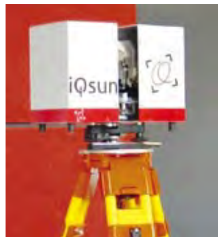
Fig. 38 - Lo scanner Time Of Flight sviluppato da iQsun , si tratta di una strumentazione con funzionalità panoramiche ed un ingombro molto contenuto.
