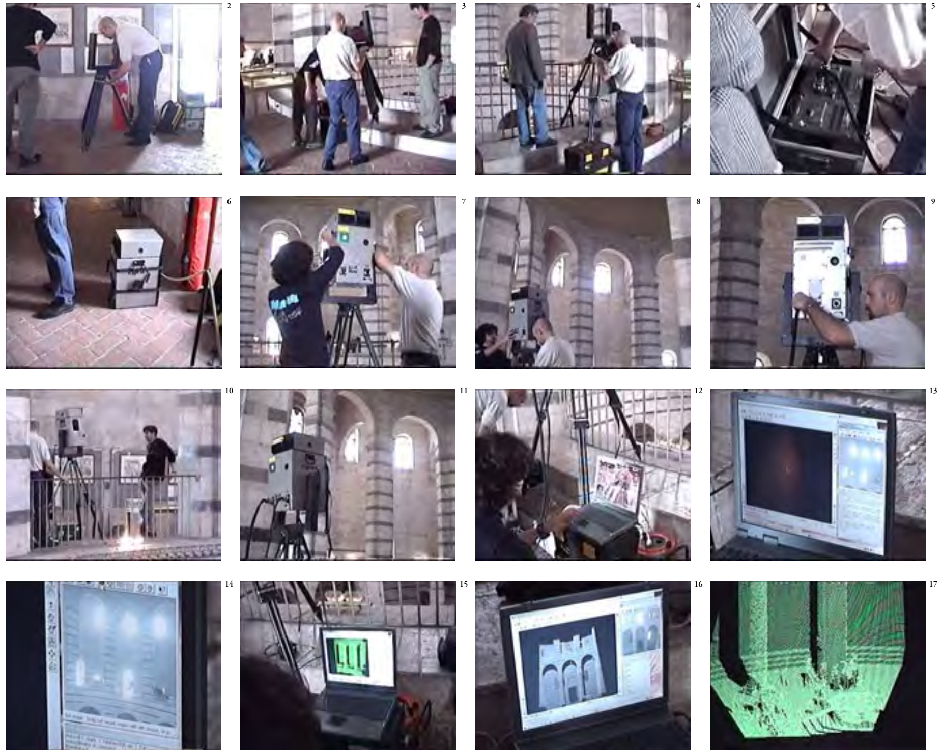
Figg. 2/17 - Sequenza delle operazioni per l'esecuzione di una scansione con scanner laser Cyrex 2400 : messa in opera della strumentazione, configurazione della parte software, inquadramento della ripresa, esecuzione della scansione generale, controllo dei risultati.
