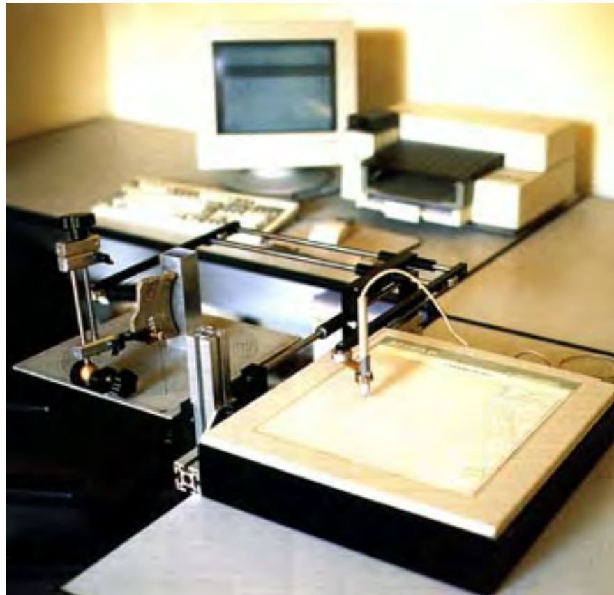
Fig. 13 - Sistema di rilievo bidimensionale sviluppato per il tracciamento dei profili di un oggetto, la sua applicazione principale sono le misurazioni di reperti archeologici.
