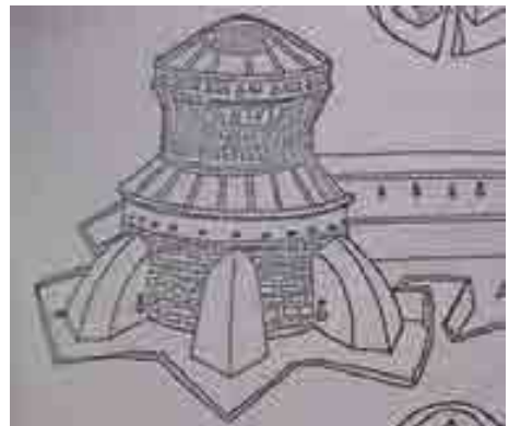
Fig. 5- Francesco di Giorgio Martini, Codice Magliabechiano II.I.141, f.203v. Torrione con sproni a mandorla, fossato zigzagato, trattamento murario bugnato e antemurale ricoperto a falda.
