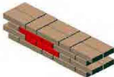
Fig. 3- Apparecchiatura muraria "alla gotica".
