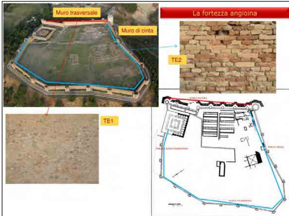
Fig.3- Cinta muraria della fortellicia angioina, differenti tecniche costruttive adottate.
