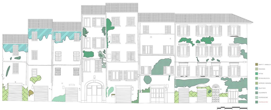
Fig. 9: Esempio di tavola tematica di un edificio, rappresentazione del degrado.
