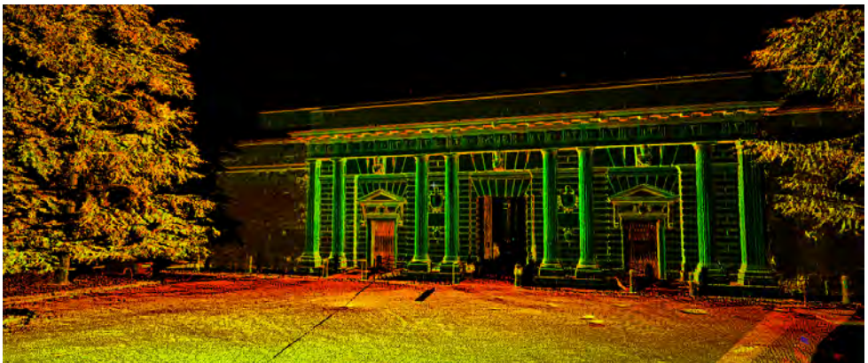
Fig. 8- Nuvola di punti di Porta Palio con visualizzazione silhouette.
