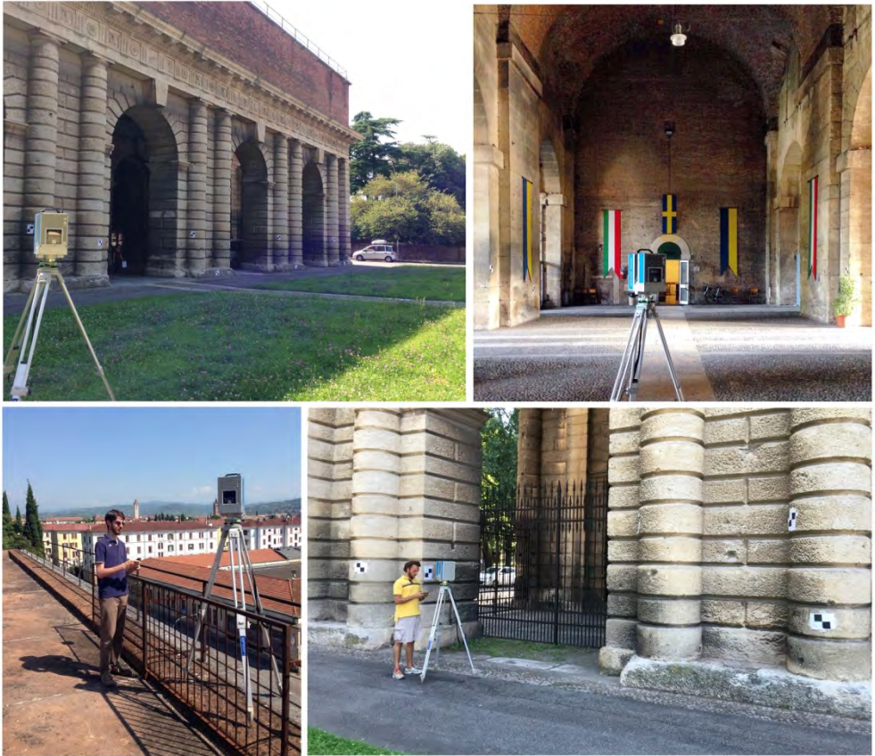
Fig. 6- Attività di rilievo laser scanner presso Porta Palio.
