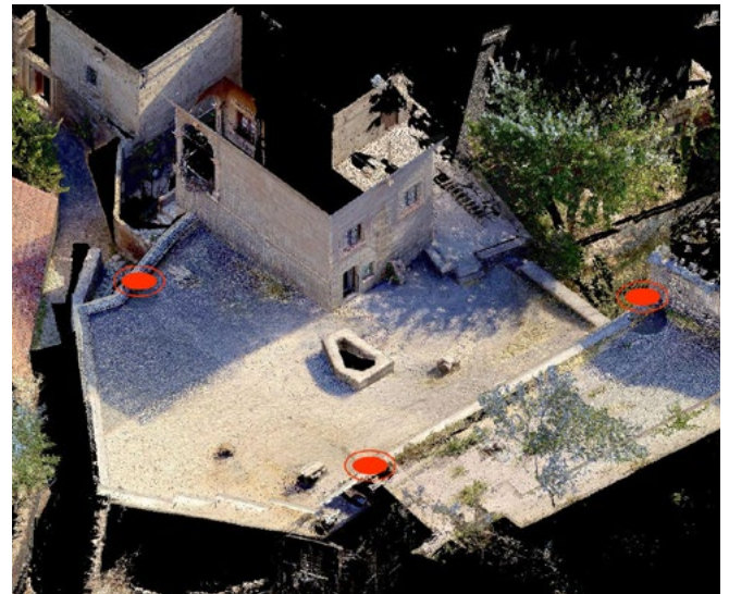
Vista assonometrica di tre nuvole di punti allineate e registrate. In rosso sono evidenziate le posizioni dello strumento al momento delle prese delle misure. Immagine estratta dal programma Leica geosystem Cyclone.
