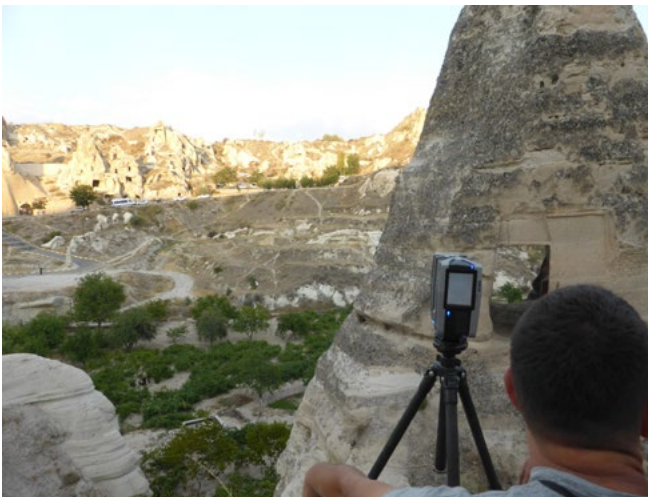
Fasi di rilievo di una piccola chiesa a Göreme eseguito con scanner Faro Focus3D (sistema a differenza di fase)
