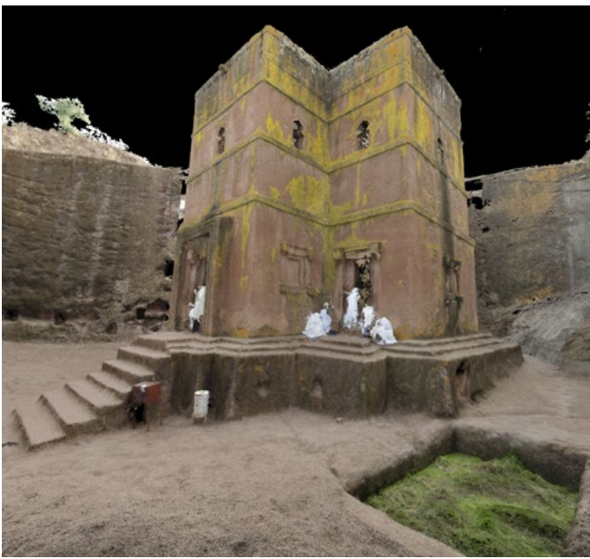
Viste prospettive e dettaglio del portale d'ingresso estratte dalle nuvole di punti
