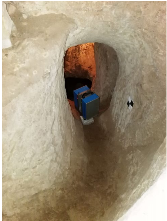
Fasi di rilievo di uno dei cunicoli della casa di Mimar Sinan ad Ağırnas eseguito con scanner Z+F (foto di Francesco Tio)
