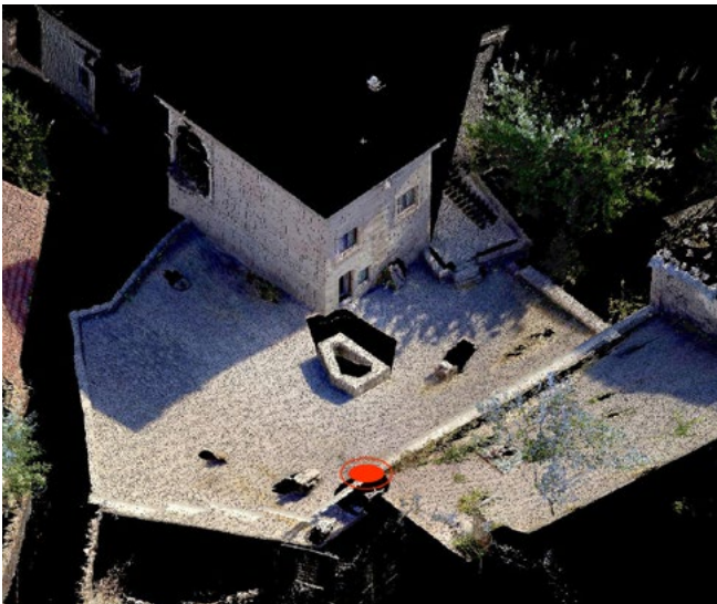
Vista assonometrica di una singola nuvola di punti che compone il modello totale. In rosso è evidenziata la posizione dello strumento al momento della presa delle misure. Immagine estratta dal programma Leica geosystem Cyclone.
