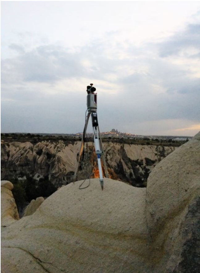
Il rilievo del paesaggio della valle di Göreme eseguito con scanner Riegl (foto di Francesco Tioli)
