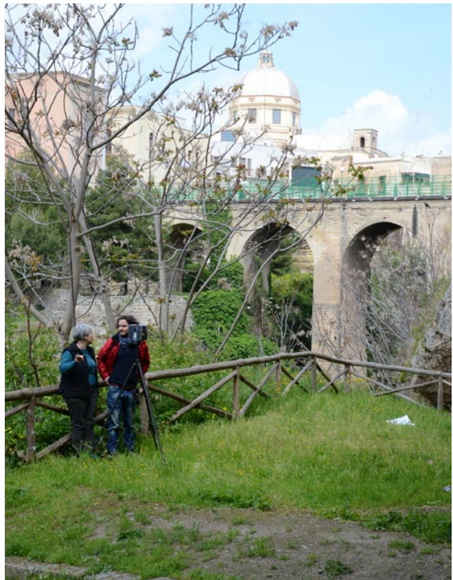
Fasi di rilievo con scanner Faro Focus3D
