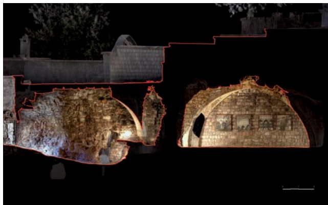
Rappresentazione finale di una delle sezioni realizzate per descrivere l'ambiente B ottenuta sovrapponendo le polilinee che costituiscono la linea di sezione e l'immagine corrispondente
