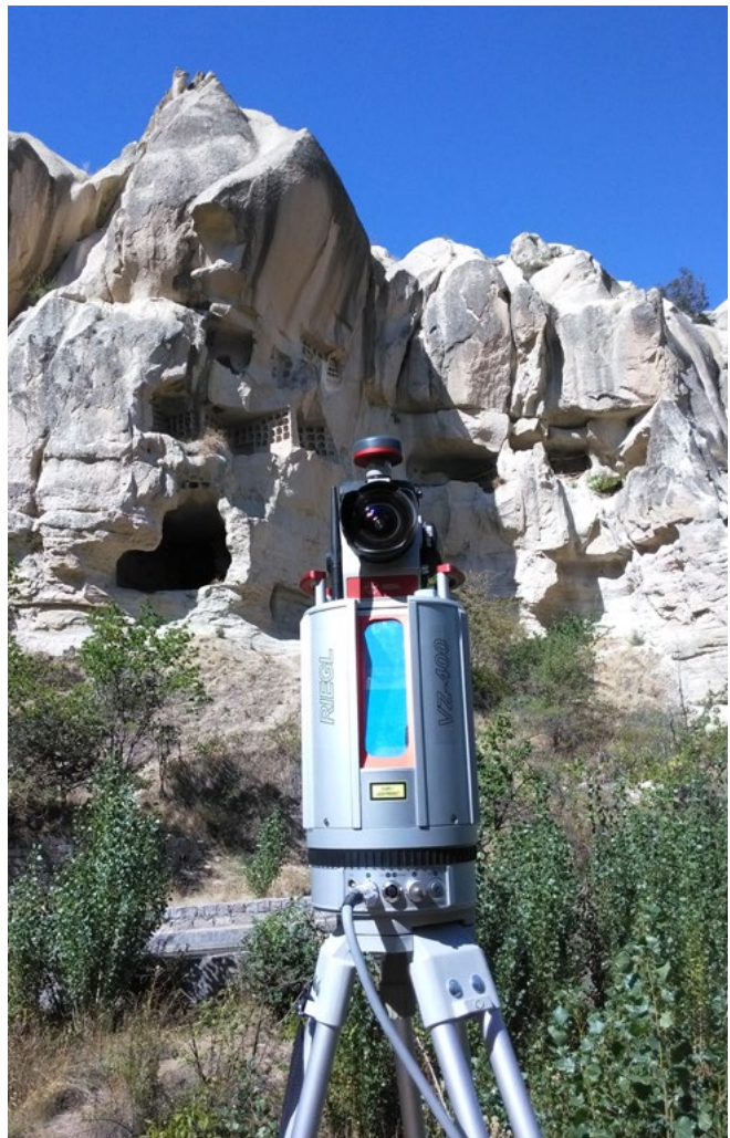
Fasi di rilievo del paesaggio della valle di Göreme eseguito con scanner Riegl (sistema a tempo di volo con fotocamera esterna) (foto di Francesco Tioli)
