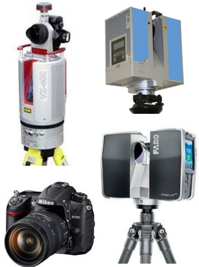
Gli strumenti usati per il rilievo. da in alto a sinistra: laser scanner Riegl VZ-400; laser scanner Z+F 5006h ; fotocamera digitale Canon D 7000; laser scanner FARO Focus 3D.
