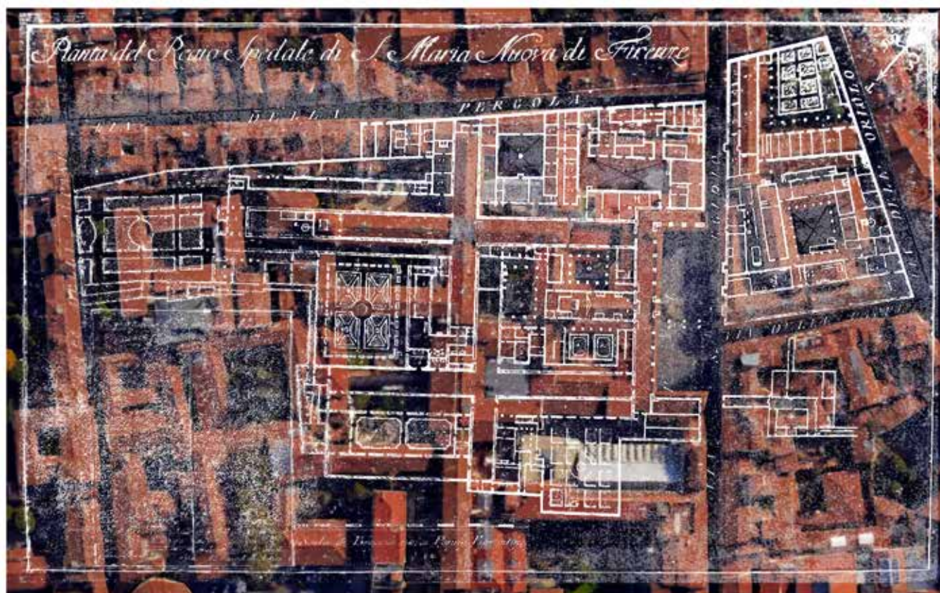
Fig. 125: sovrapposizione della planimetria del 1789 con la foto aerea dello stato attuale.
