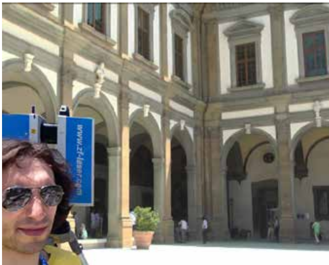
Fig. 126: Fase di acquisizione strumentale attraverso lo Scanner Laser ZF 5006H, utilizzato per la campagna di rilievo.
