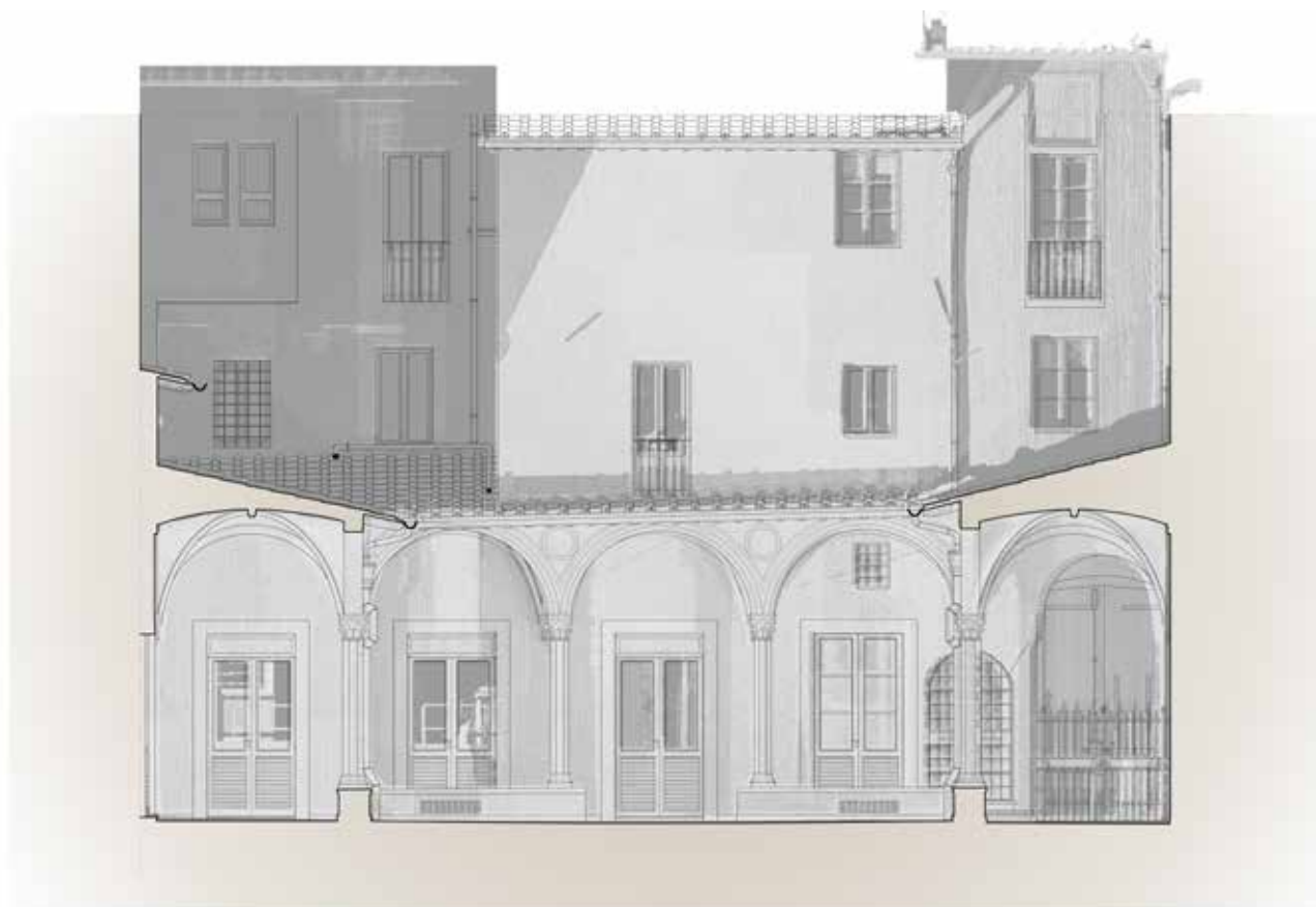
Fig. 129-130-131-132-133: Screenshot delle nuvole di punti acquisite durante la campagna di rilievo, sovrapposte con gli elaborati grafici realizzati. In alcuni casi come in quello della zona absidale della Chiesa di S.Egidio è stato fondamentale l'integrazione del rilievo diretto con quello strumentale. Vista Plani, Pianta Chiesa di Sant'Egidio, Sezione Longitudinale e Trasversale Chiesa di Sant'Egidio; Prospetto Nord e Sud Chiostrò delle Medicherie.
