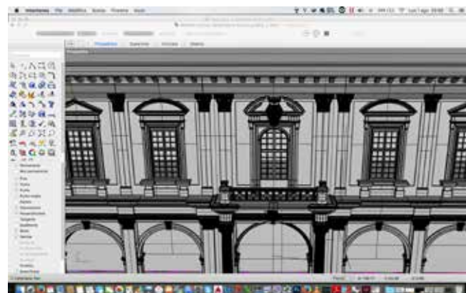
Fig. 140-141-142: Fasi di elaborazione delle nuvole di punti e fasi di modellazione con il Software Rhinoceros.
