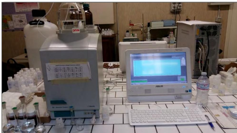
Figura 22 Cromatografo ionico Metrohm 861 Advanced Compact IC utilizzato per la determinazione dei seguenti soluti: Na, K, Mg, Ca, Li,  $\text{NH}_4^+$ .
