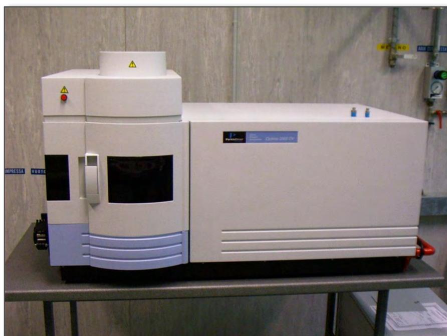
Figura 23 ICP-OES della Pelkir Elmer mod. Optima 2000 DV utilizzato per l'analisi di Fe, Mn, Sr, Ba.
