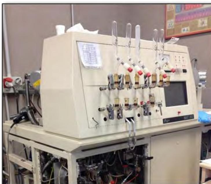
Figura 27 Analisi del  $\delta^{13}\text{C}$  del carbonio della  $\text{CO}_2$  disciolta in acqua ( $\delta^{13}\text{C}\text{-CO}_2\text{STRIP}$ ).
