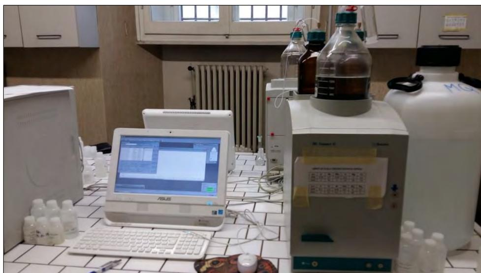
Figura 21 Cromatografo ionico Metrohm 761 Compact IC utilizzato per la determinazione dei seguenti soluti: F, Cl, Br, NO<sub>3</sub>, PO<sub>4</sub> e SO<sub>4</sub>.
