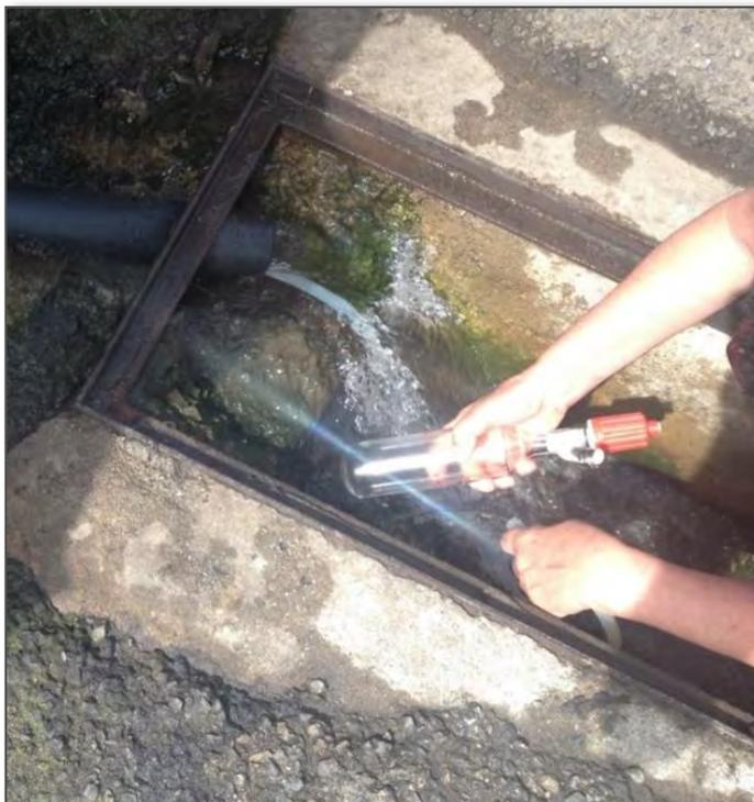
*Figura 25 Ampolla cilindrica utilizzata per il prelievo dei gas disciolti secondo il metodo di Tassi et al. (2008).*
