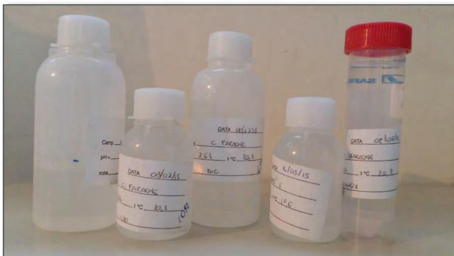
Figura 20 Contenitori in polietilene utilizzati per il campionamento delle acque.
