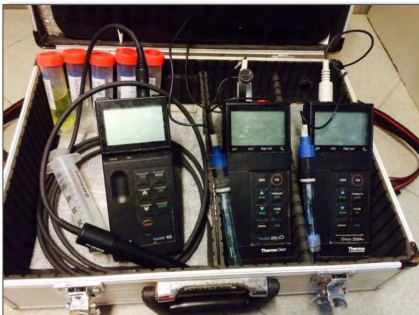
Figura 19 Attrezzatura portatile utilizzata per la misura di temperatura, conducibilità elettrica (Thermo Orion Conductivity meter, 3 Star), pH (Thermo Orion pHmeter 3 Star) ed Eh (Thermo Orion, model 250).
