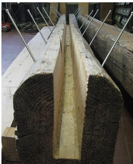
Figura 57 – Estrazione dei connettori e rimozione del pannello di rinforzo (BauBuche) dopo la prova di rottura. Dalla figura è possibile notare come le viti siano sostanzialmente dritte.
