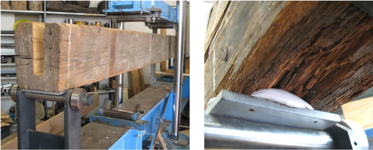
Figura 32 – Collocamento di una trave sugli appoggi per la prova a flessione con la scanalatura verso l'alto (foto di sinistra) e utilizzo del gesso tra la piastra e la superficie della trave degradata (foto di destra).
