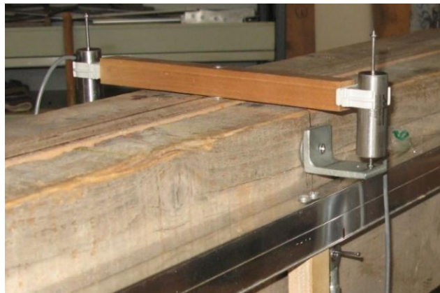
Figura 34 – Coppia di trasduttori collegati all'estradosso del rinforzo per la misura dello scostamento tra i due elementi in mezzzeria
