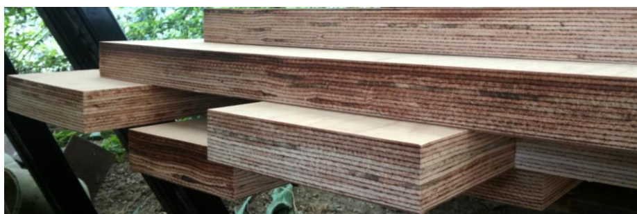
Figura 13 – LVL di faggio prima della sezionatura
