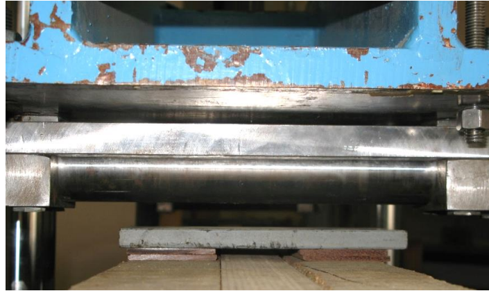
Figura 35 – Applicazione del carico alla sola trave per testare il livello di collaborazione tra gli elementi del composito. Le piastre d'acciaio, utilizzate per la ripartizione dei carichi, venivano rialzate con delle lamine di legno di Azobè 6 , così da non caricare il rinforzo.
