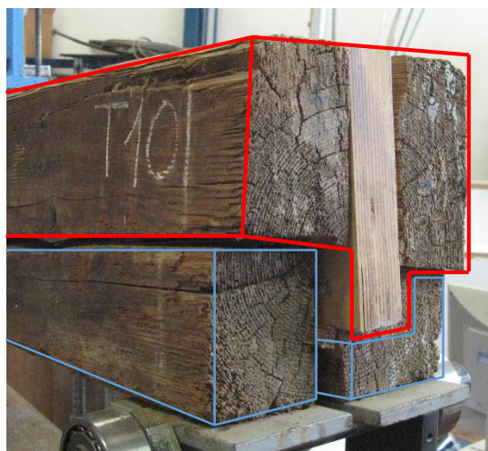
Figura 55 – Parzializzazione della sezione durante le prove ultime di rottura. In rosso è evidenziata la sezione composta a "T" formata dal rinforzo come anima centrale e i due lembi di trave connessi con le viti. La parte inferiore, in questo caso, indicata in blu si è ulteriormente suddivisa in due parti in corrispondenza di una fessura da ritiro. Da notare anche lo spostamento delle piastre di appoggio causato dalla separazione della parte sottostante.
