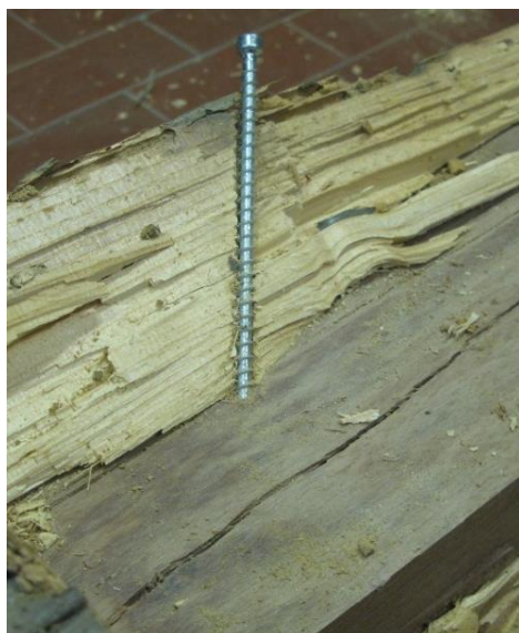
Figura 58 – Connettore avvitato nel pannello Ranprex. Anche in questo caso è possibile constatare la non curvatura della vite.
