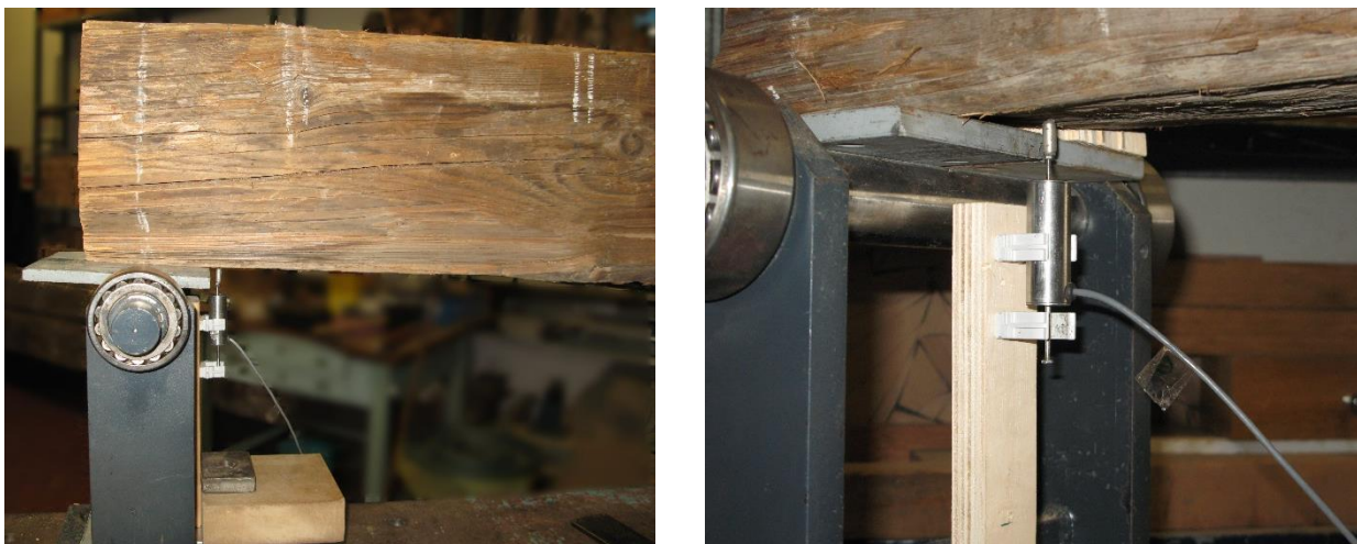
Figura 38 – Trasduttori di spostamento per la misura dell'abbassamento della trave in prossimità degli appoggi.
