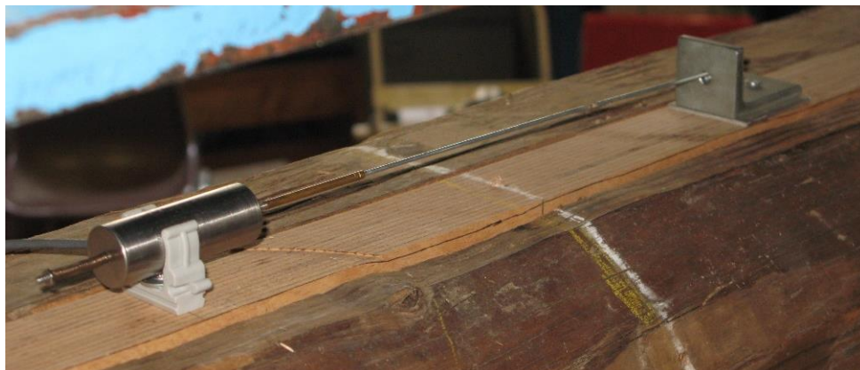
Figura 39 – Il trasduttore di spostamento utilizzato per il rilevamento dell'accorciamento relativo dell'estradosso e indirettamente dell'istante in cui è avvenuta la rottura del rinforzo durante la prova. La linea bianca trasversale indica la metà della trave.
