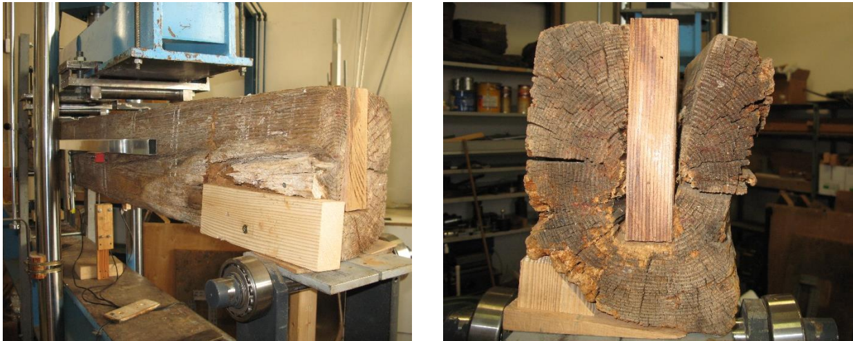
Figura 37 – Esempi di riparazioni delle testate di due travi per consentire un appoggio distribuito e uniforme sulle piastre.
