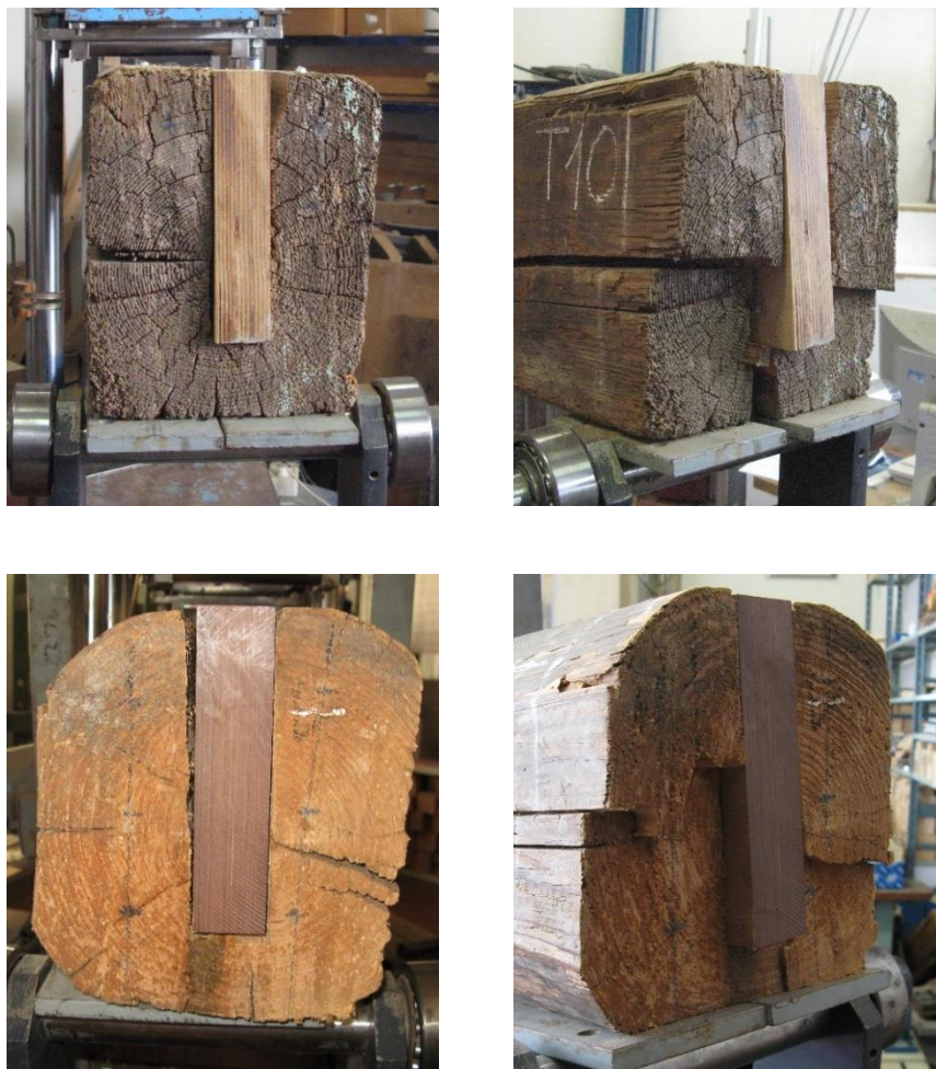
Figura 48 – Frazionamento della sezione della trave causate da rotture a taglio in corrispondenza di fessurazioni da ritiro passanti e cipollatura. In alto il campione T10 rinforzato con il pannello BauBuche prima (foto di sinistra) e dopo la prova (foto di destra). In basso il campione T04 rinforzato con il pannello densificato Ranprex prima (foto di sinistra) e dopo la prova di rottura (foto di destra).
