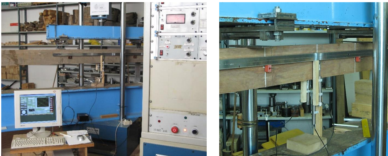
Figura 33 – Nella foto di sinistra è raffigurata la macchina prova materiali Metrocom e il sistema di acquisizione dei dati durante la prova di una trave. La foto di destra mostra i tre trasduttori per la determinazione di E_{ml} e E_{mg} posizionati per il test di un pannello densificato.
