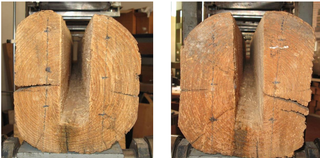
Figura 20 – Le due testate della trave T04 in cui è ben visibile la presenza di una fessurazione profonda e passante per quasi tutta la lunghezza dell'elemento. Il midollo, che in questo caso era centrato, è stato completamente asportato per la realizzazione della scanalatura.
