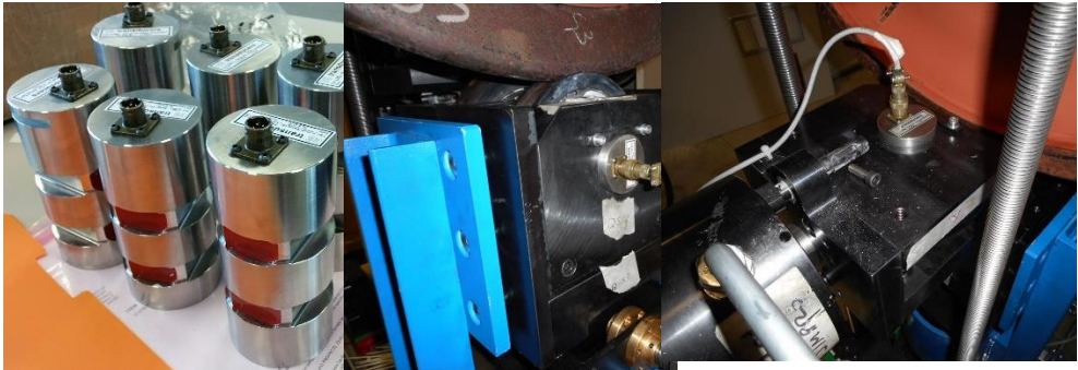
Figura 36 – Celle perno (sinistra). Montaggio nel gruppo della forza radiale (centro). Montaggio nel gruppo della forza assiale (destra).
