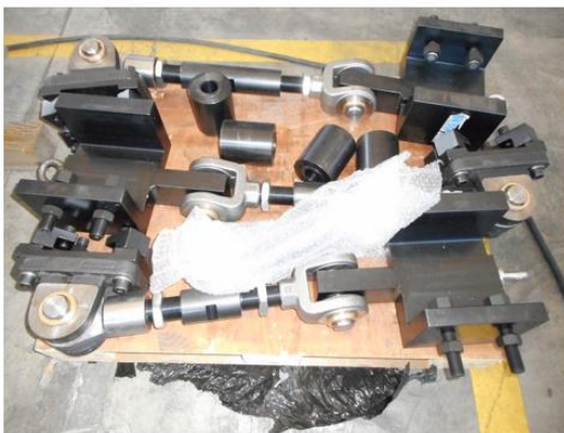
Figura 10 – Alto: montaggio del telaio supplementare. Centro e basso: componenti che costituiscono i tiranti fissi e quello mobile. Da sinistra: dettaglio della pinza, attuatore, tiranti fissi, dettaglio della cerniera inferiore.
