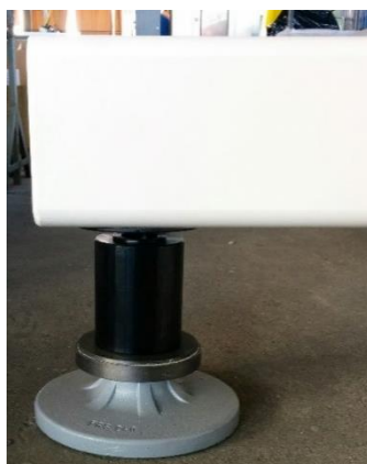
Figura 2 – Alto: Telaio a costruzione ultimata. Centro e basso: particolari. Si evidenziano sia la sezione irrigidita mediante lamiera laterali sia il sistema di ancoraggio rispetto alla pavimentazione.
