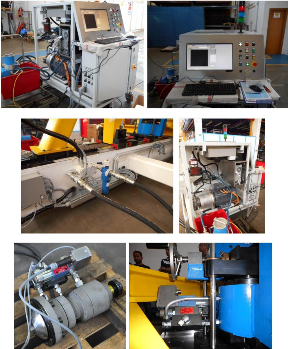
Figura 12 – Alto: centrale mobile carrellata al cui interno sono presenti i componenti principali del circuito oleodinamico, assieme agli azionamenti principali. Centro: dettaglio del circuito, a bordo banco è prevista una tubazione rigida che consente di ridurre le oscillazioni di pressione dell'olio che alimenta le servovalvole montate sui cilindri (sinistra). Basso: installazione delle servovalvole sugli attuatori.
