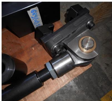
Figura 10 – Alto: montaggio del telaio supplementare. Centro e basso: componenti che costituiscono i tiranti fissi e quello mobile. Da sinistra: dettaglio della pinza, attuatore, tiranti fissi, dettaglio della cerniera inferiore.
