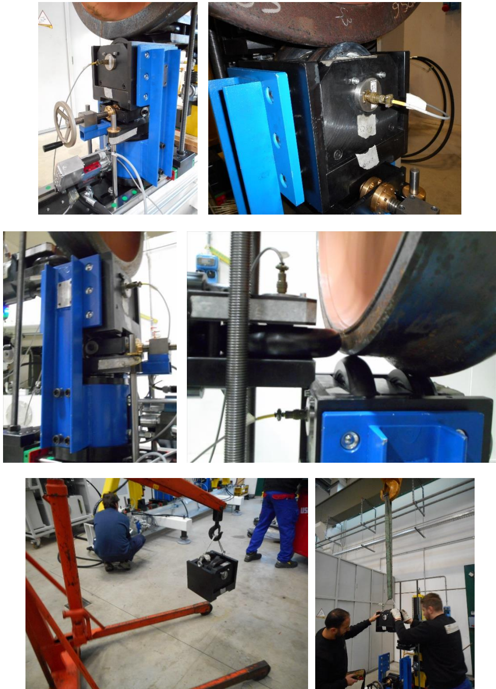
Figura 3 – Alto e centro: unità completa di celle di carico con la sala. Basso: fasi di movimentazione.
