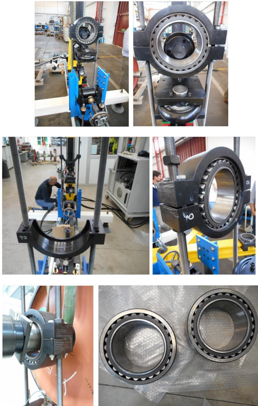
Figura 7 – Alto e centro: viste generali del gruppo durante il montaggio. Basso: montaggio dell'unità sul fusello e particolare dei cuscinetti impiegati.
