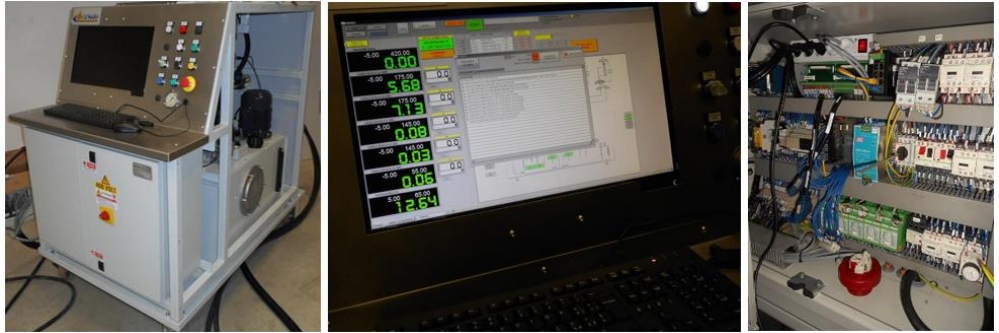
Figura 35 – Centrale di comando (sinistra). Frontale di acquisizione (centro). Visione d'insieme del circuito (destra).
