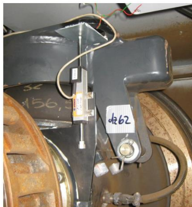
Figura 1 – Misura della deformazione verticale in una sospensione primaria [2].
