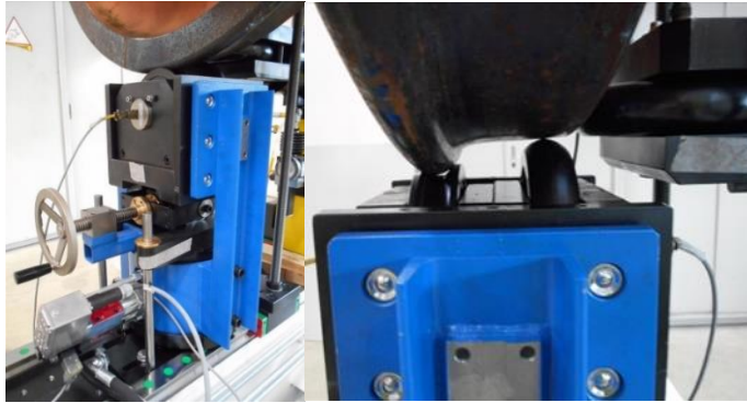
Figura 24 – Vista generale del sottogruppo (sinistra). Ingrandimento del posizionamento di una ruota su i due rulli (destra).
