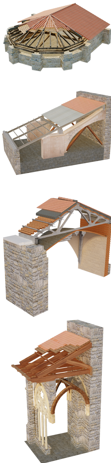
Fig. 4 Modelli 3D illustrativi degli interventi di restauro realizzati nel tempo: (dall'alto) copertura lignea dell'abside; copertura in acciaio delle navate laterali; copertura in c.a. della navata centrale; copertura del chiostro in legno lamellare
