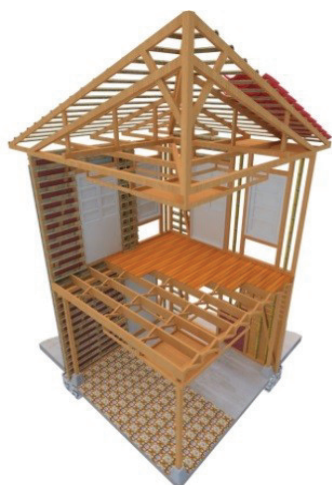
Figura 9: Bahareque de Tierra sobre columnas de madera.
