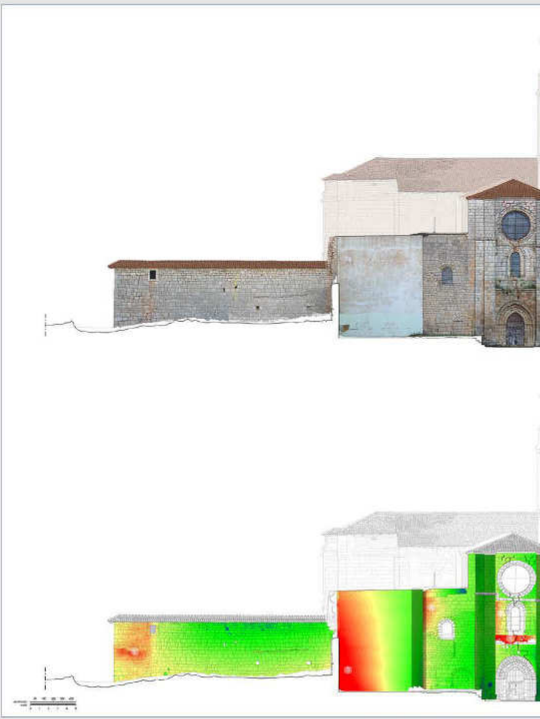
RILIEVO STRUTTURALE E CONSOLIDAMENTO Prospetto Ovest: quadro fessurativo ed elevation map - scala 1:100
