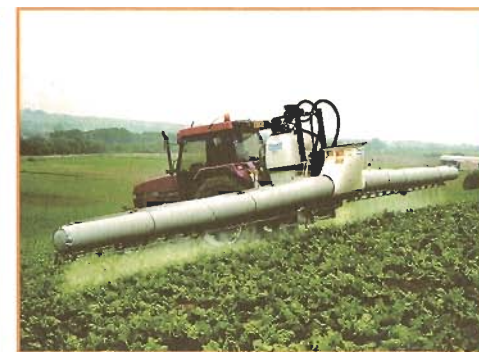
Fig. 3 Barra aeroassistita. Fonte: DIAF
