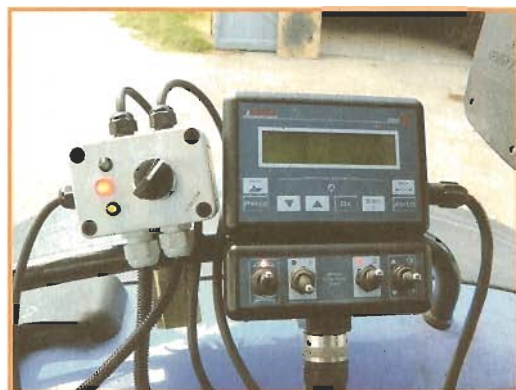
Fig.10 Dispositivo per il monitoraggio della carica elettrostatica durante il trattamento. Fonte: Nobili S.p.A.
