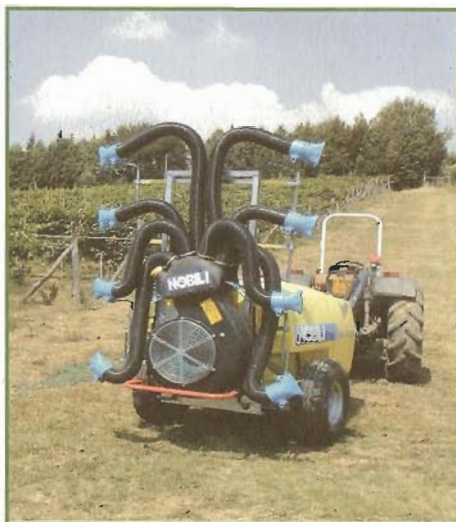
Fig. 6 Irroratrice a getti orientabili (i moduli di irrorazione possono essere regolati indipendentemente e direzionati sulle diverse zone vegetative) . Fonte: DIAF
