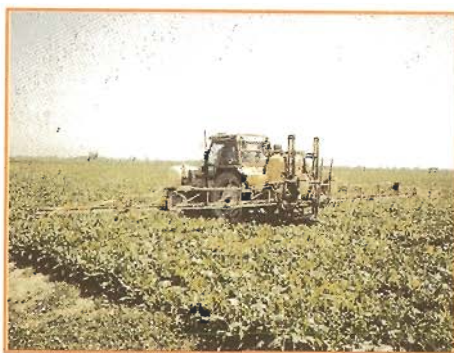
Fig. 2 Barra irroratrice priva di aeroconvezione. Fonte: DIAF
