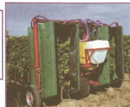
Fig. 8 Irroratrice a tunnel con possibilità di recupero della miscela non irrorata direttamente sul "bersaglio" . Il contenimento della deriva è massimo. Fonte: Lochmann - plantatec
