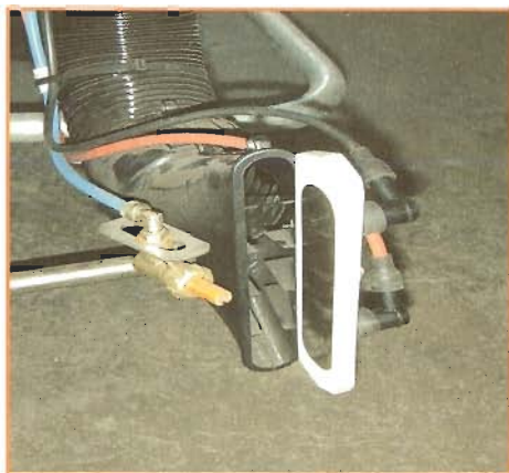
Fig. 9 Elettrodo applicato a una bocchetta di un atomizzatore. Fonte: Nobili S.p.A.
