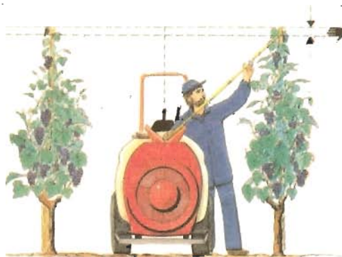
Fig. 16 Regolazione dei deflettori in base alla conformazione del bersaglio. Fonte: Syngenta
