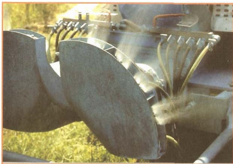
Fig. 5 Irroratrice pneumatica . Fonte: DIAF
