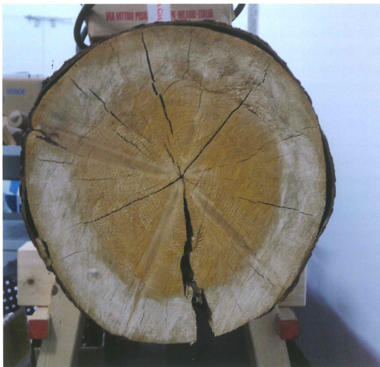
3. A sinistra particolare della tavola armonica del Messia . La fascia chiara al centro in corrispondenza della giunzione delle tue tavole, corrisponde all'alburno (foto M. Malagodi). A destra, testata di tronco di Abete rosso caratterizzata dalla presenza dell'anomala colorazione del durame (foto M. Bernabei).
