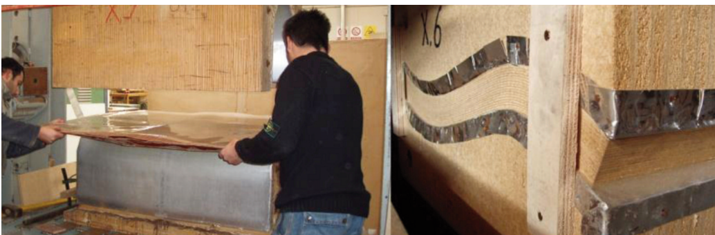
Fig. 18 - Fase di lavorazione del compensato curvato nell'azienda partner del progetto CS Curvati di Pistoia.
