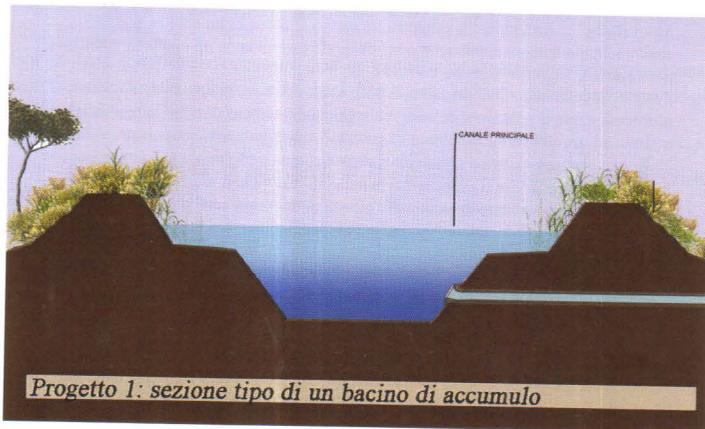
Progetto 1: sezione tipo di un bacino di accumulo
