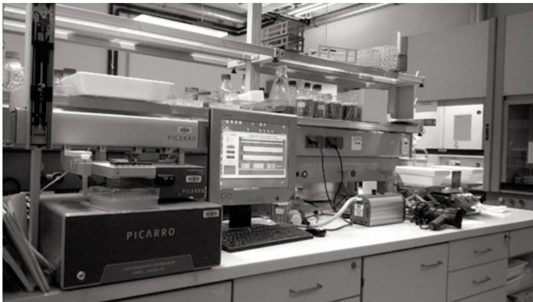
Fig. 5 - Spettrometro laser in uso presso la facoltà di Scienze e Tecnologie della Libera Università di Bolzano-Bozen. Alla sua destra, l'apparato per l'estrazione criogenica di acqua. Il campione viene scaldato per far evaporare l'acqua dal campione che poi viene condensata in una trappola di azoto liquido (Koeniger et al. , 2011).
